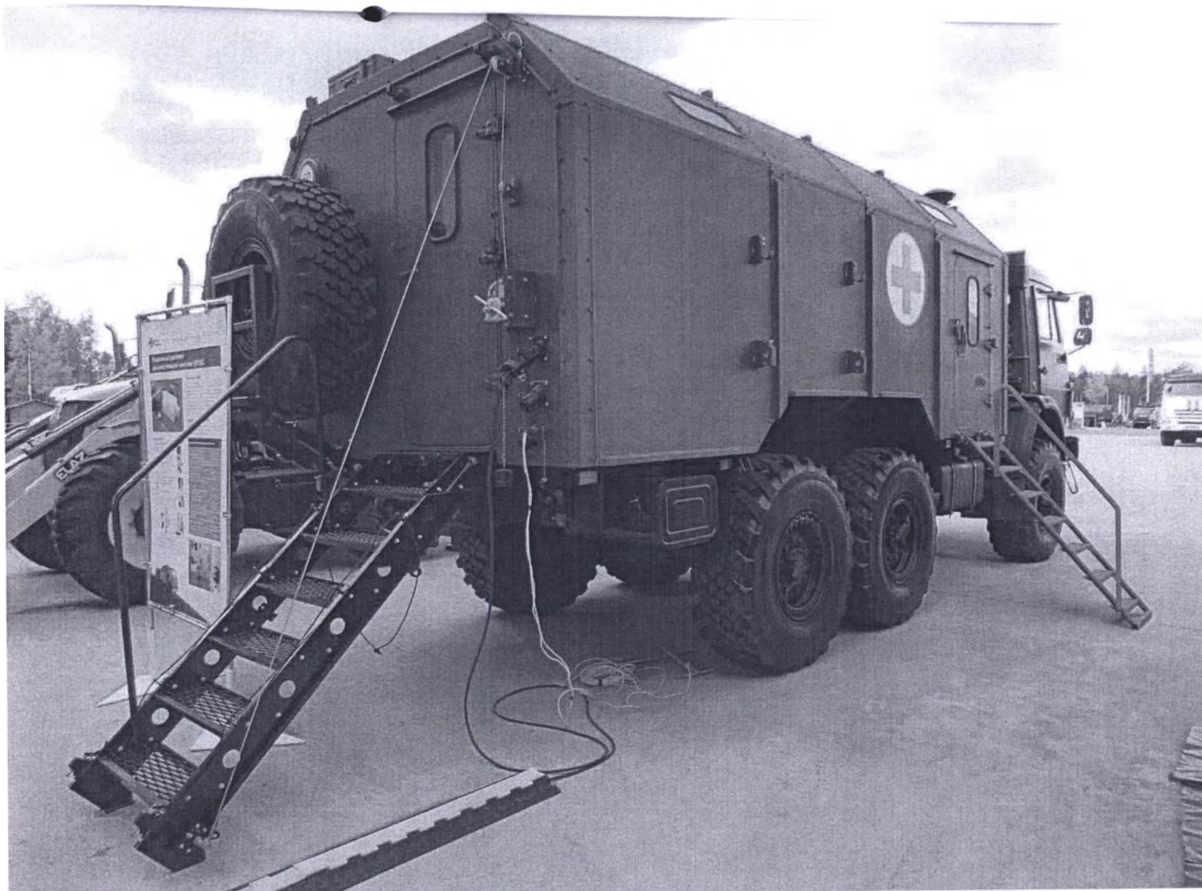
Фотография 2. Подвижный рентгенодиагностический кабинет ПРДК по ТУ 29.10.59-001-59563632-2019. Развернутое (рабочее) положение.
