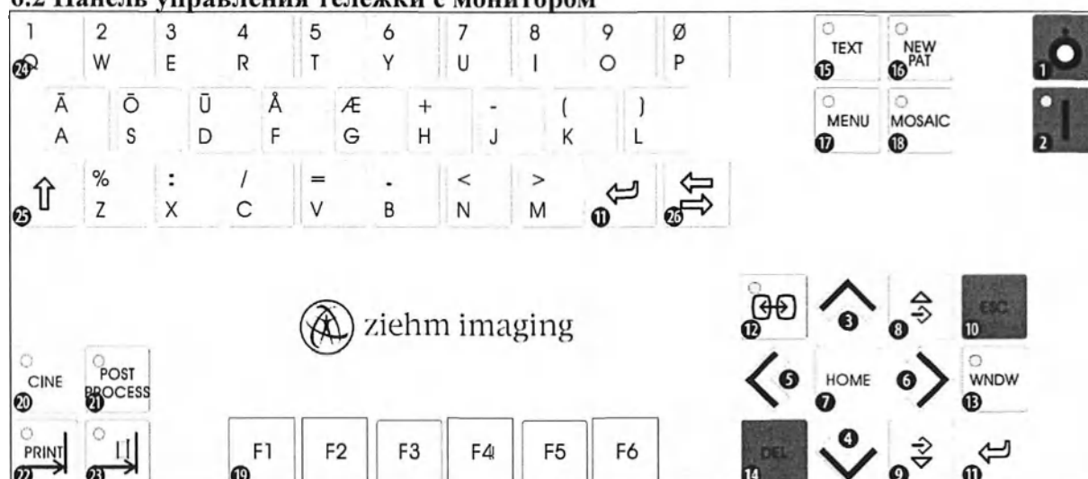
Рисунок 6-2 Панель управления тележки с монитором
