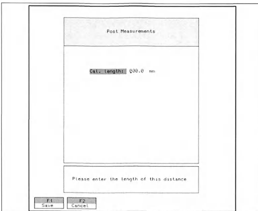
Рисунок 14-6 Меню Post Processing (последующая обработка изображений), подменю Post Measurements (последующее измерение), калибровка
