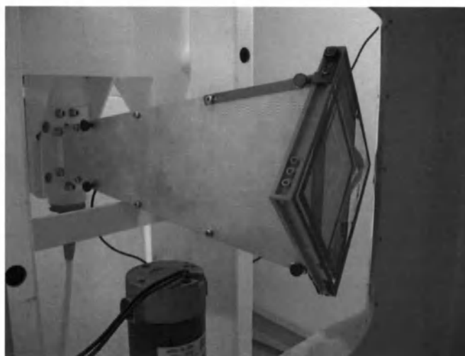
Рисунок Б.15 Закрепление камеры дозиметра ДРК-1 на выходе коллиматора при поставке по согласованию с заказчиком.
