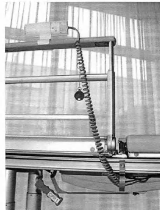
Прокладка кабеля ручного выключателя
