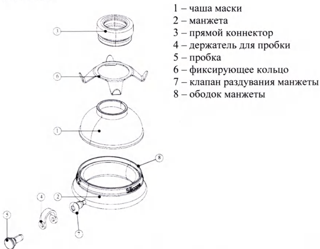
Рисунок 2.1 Схематичное изображение составных частей Маски анестезиологической из поликарбоната с манжетой размер 2 нестерильной.
