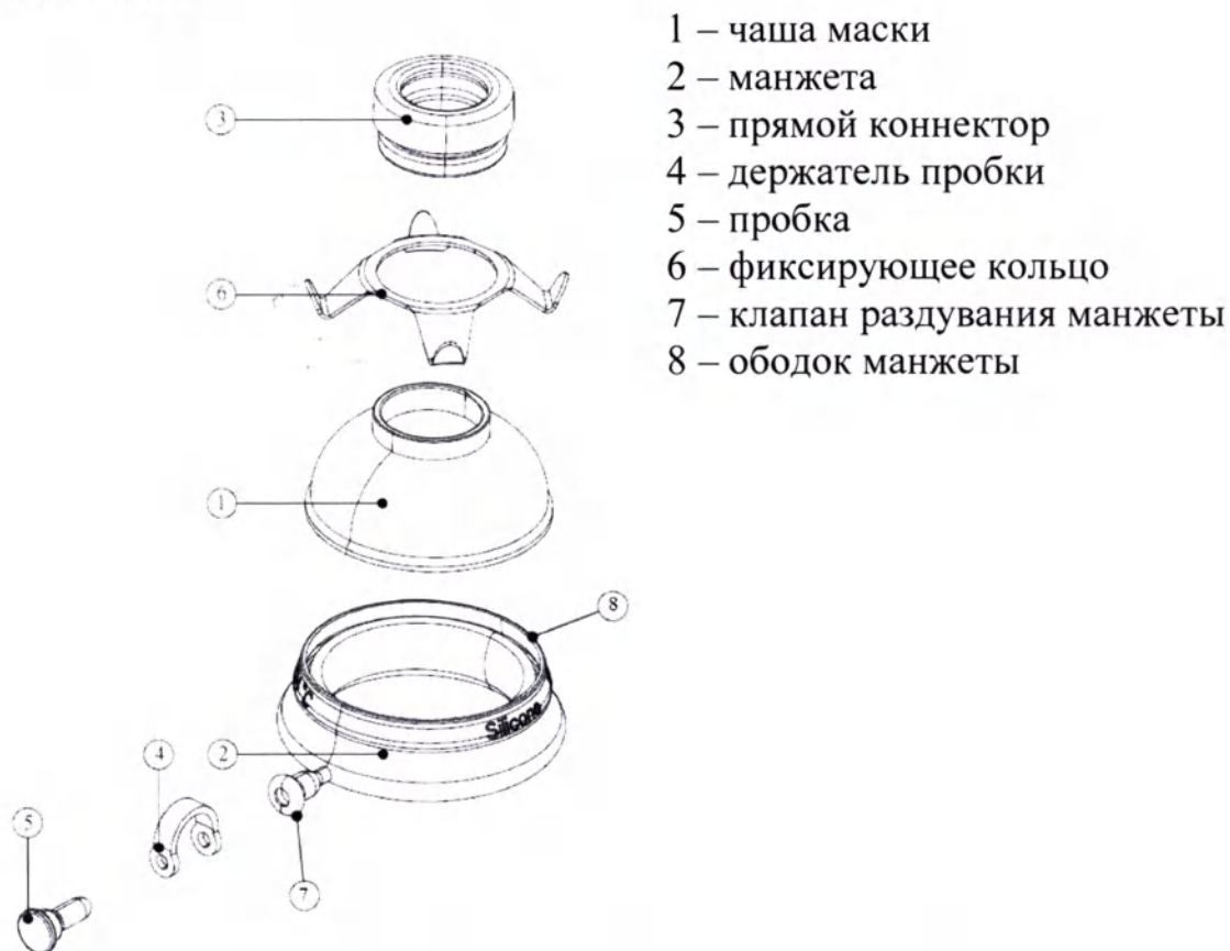
Рисунок 3.1 Схематичное изображение составных частей Маски анестезиологической из полисульфона с манжетой размер 2 нестерильной.
