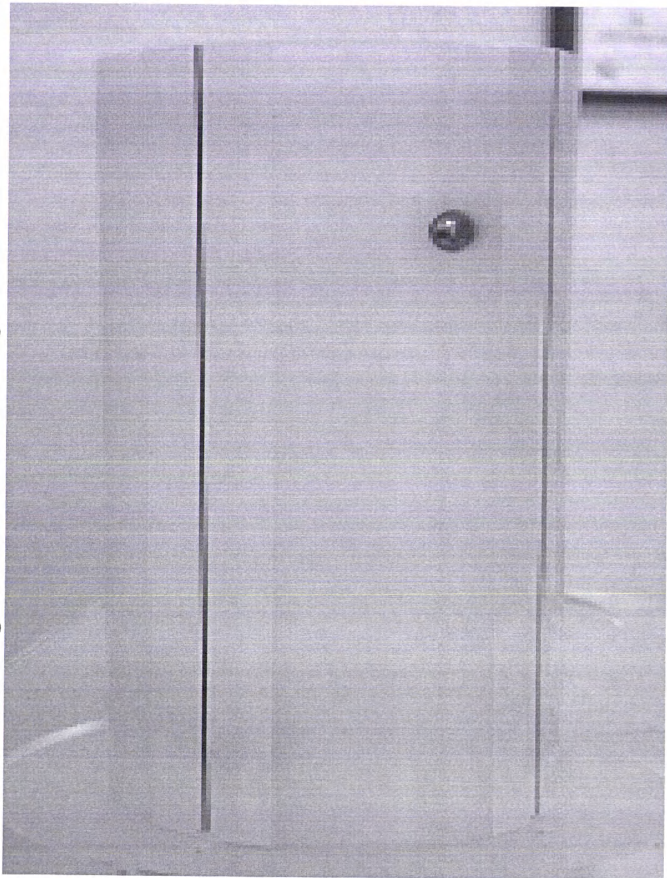
Рис. 35 Фантом для калибровки 3D-геометрии
