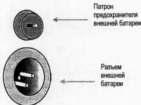
Рисунок 7.2 Разъем внешней батареи и предохранитель
