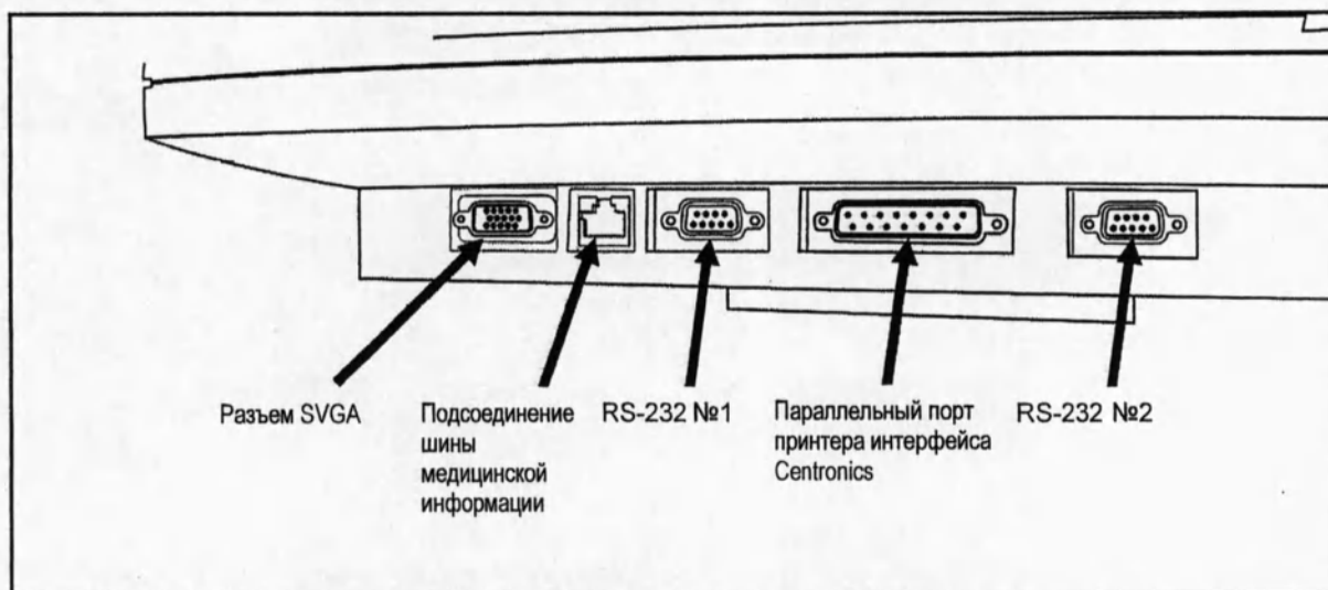
Рисунок 2.19 Расположение разъемов, находящихся под сенсорным экраном UIM
