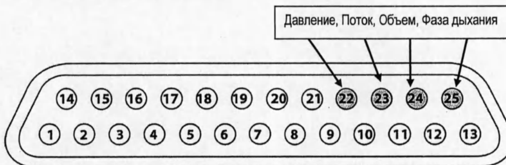
Рисунок 2.32 Конфигурация штырьков аналоговых выходов
