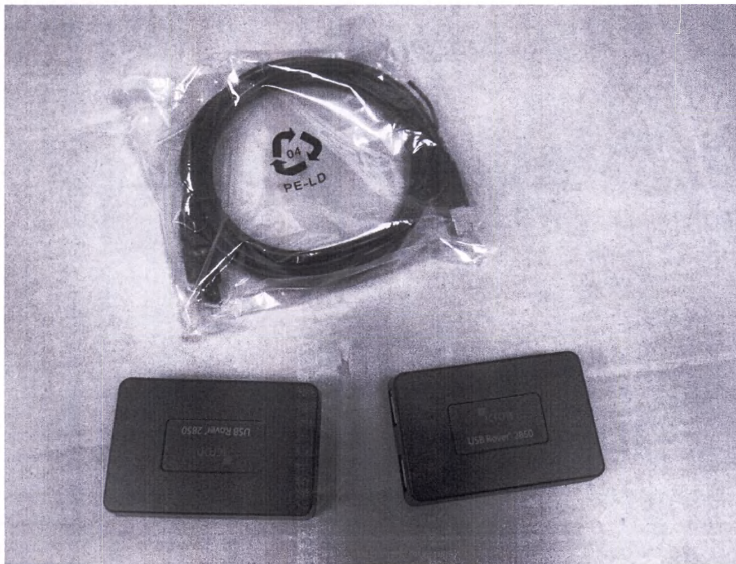
локальный удлинитель, удаленный удлинитель, кабель USB
