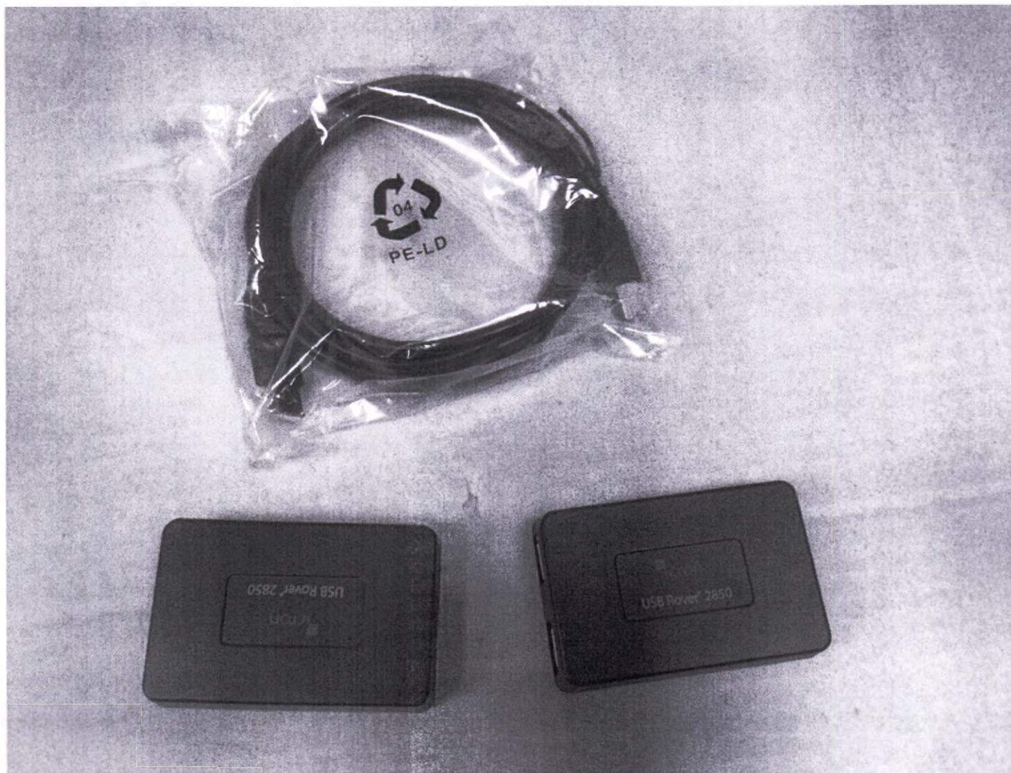
локальный удлинитель, удаленный удлинитель, кабель USB
