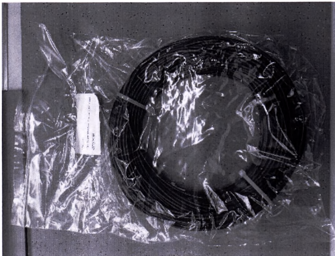
Кабель типа CoaXPress BNC-BNC, 45 м
