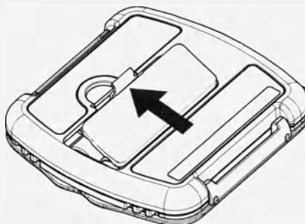
Figura 5. Vuelva a colocar la tapa del compartimento de las pilas.
