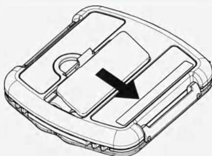
Рис. 3. Снятие крышки батарейного отсека.
