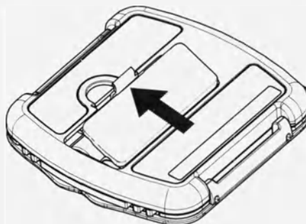
Рис. 5. Установите на место крышку батарейного отсека.
