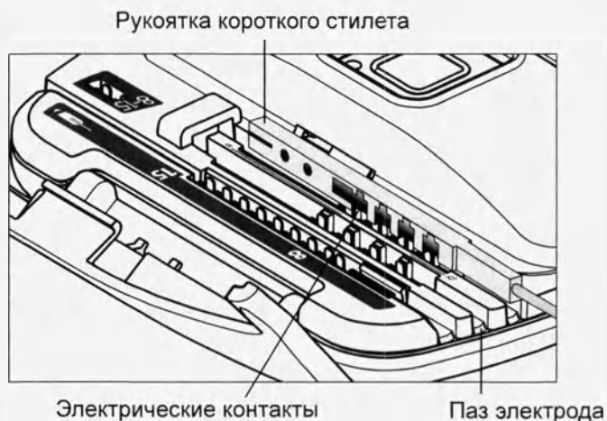
Рис. 7. Совместите контакты электрода с электрическими контактами в пазе электрода.
