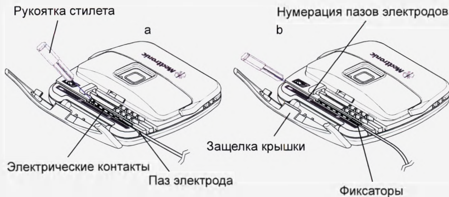
Рис. 8. Внешний нейростимулятор с 8-контактным электродом с частично извлеченным стилетом.
