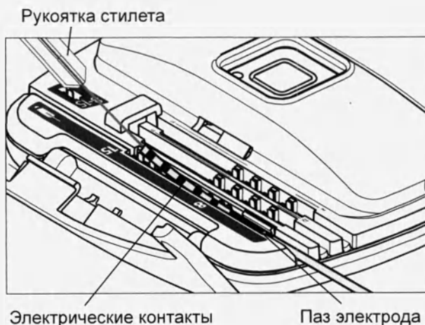
Рис. 9. Совместите контакты электрода с электрическими контактами в пазе электрода.
