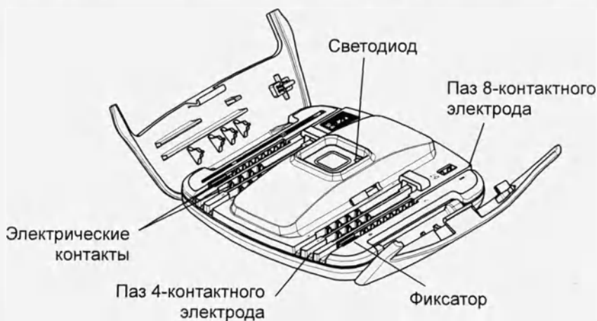
Рис. 2. Беспроводной внешний нейростимулятор модели 97725 (крышки открыты).
