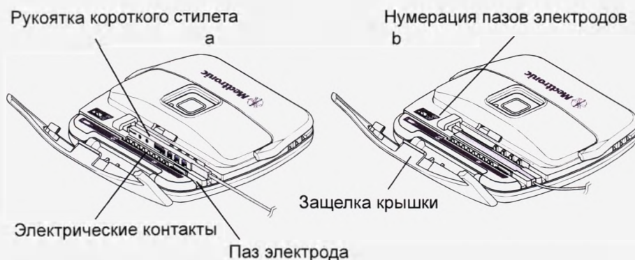
Рис. 6. Внешний нейростимулятор с 4-контактным электродом.
