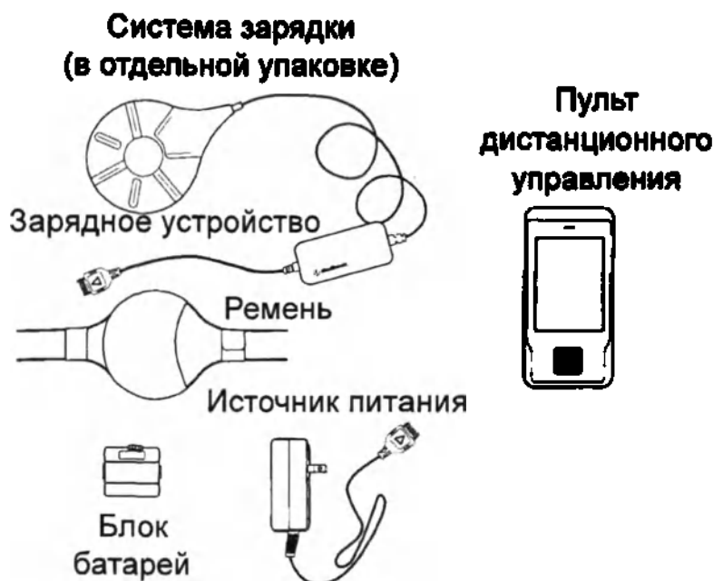
Рис. 7.1 Компоненты, используемые для зарядки перезаряжаемой системы нейростимуляции
