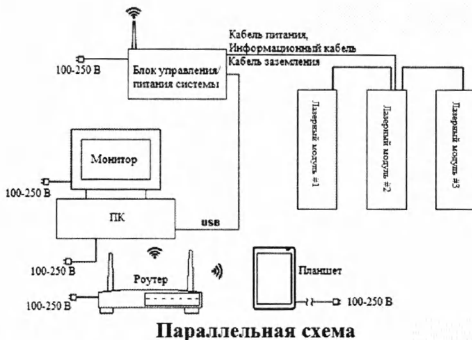
Рис.5. Схема параллельного подключения трех лазеров «CT Sim+™».
