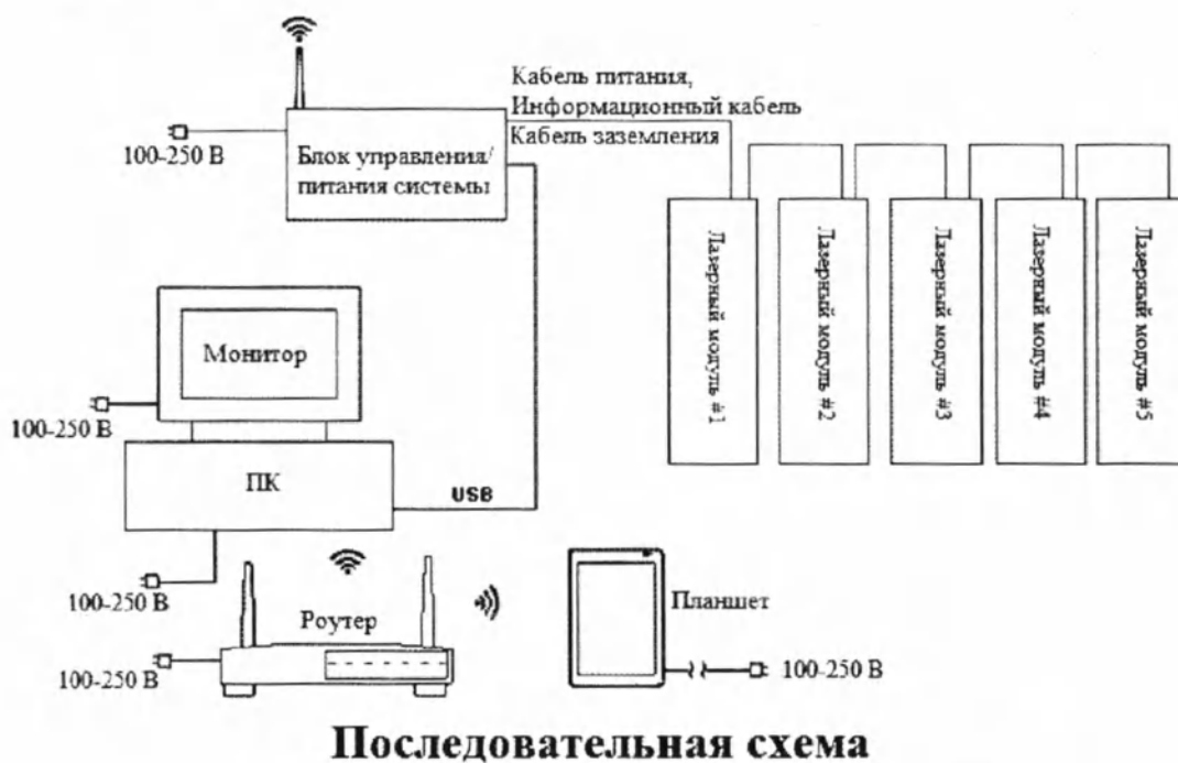
Рис.6. Схема последовательного подключения пяти лазеров «CT Sim+» (предпочтительно).
