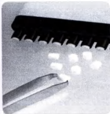
Защитные фильтры предотвращают риск контаминации
