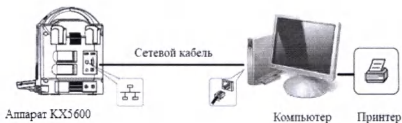
Рис. 36 Схема: Прямое подключение к аппарату KX5600
