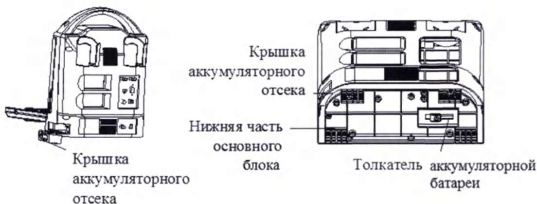
Рис.12 Установка/извлечение аккумуляторной батареи
