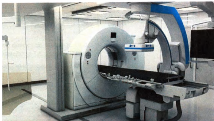
Режим КТ-сканирования с использованием стола пациента Artis
