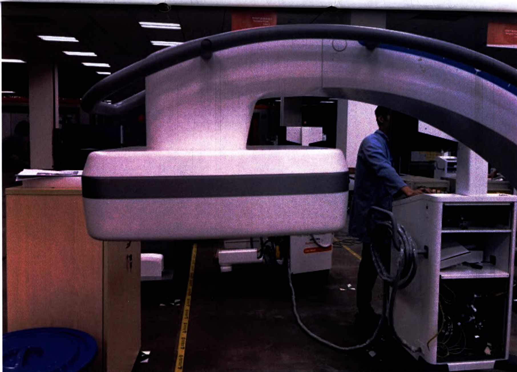
Аппарат передвижной рентгеновский С-дуга «Cios Select» в составе: С-образная дуга; рентгеновский генератор; рентгеновская трубка со встроенным коллиматором; плоский детектор; панель управления.
