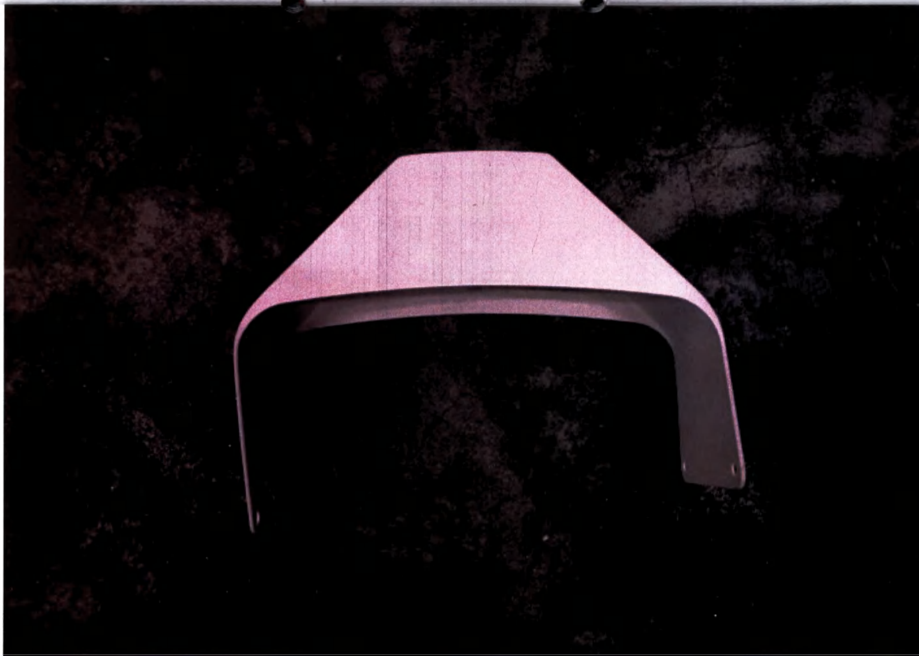
14. Проставка для обеспечения минимального расстояния фокус-кожа.
