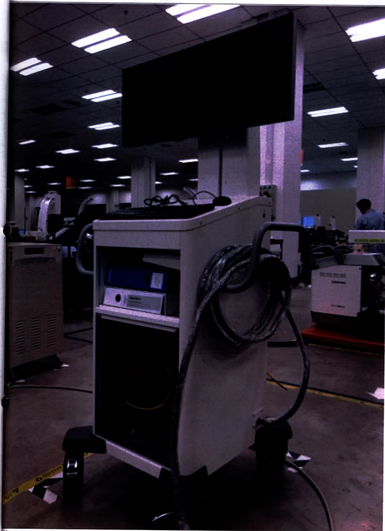
Мониторная стойка, в составе: панель управления с клавиатурой, мышь; порт USB; монитор, 2 шт.; дисковод для дисков DVD.
