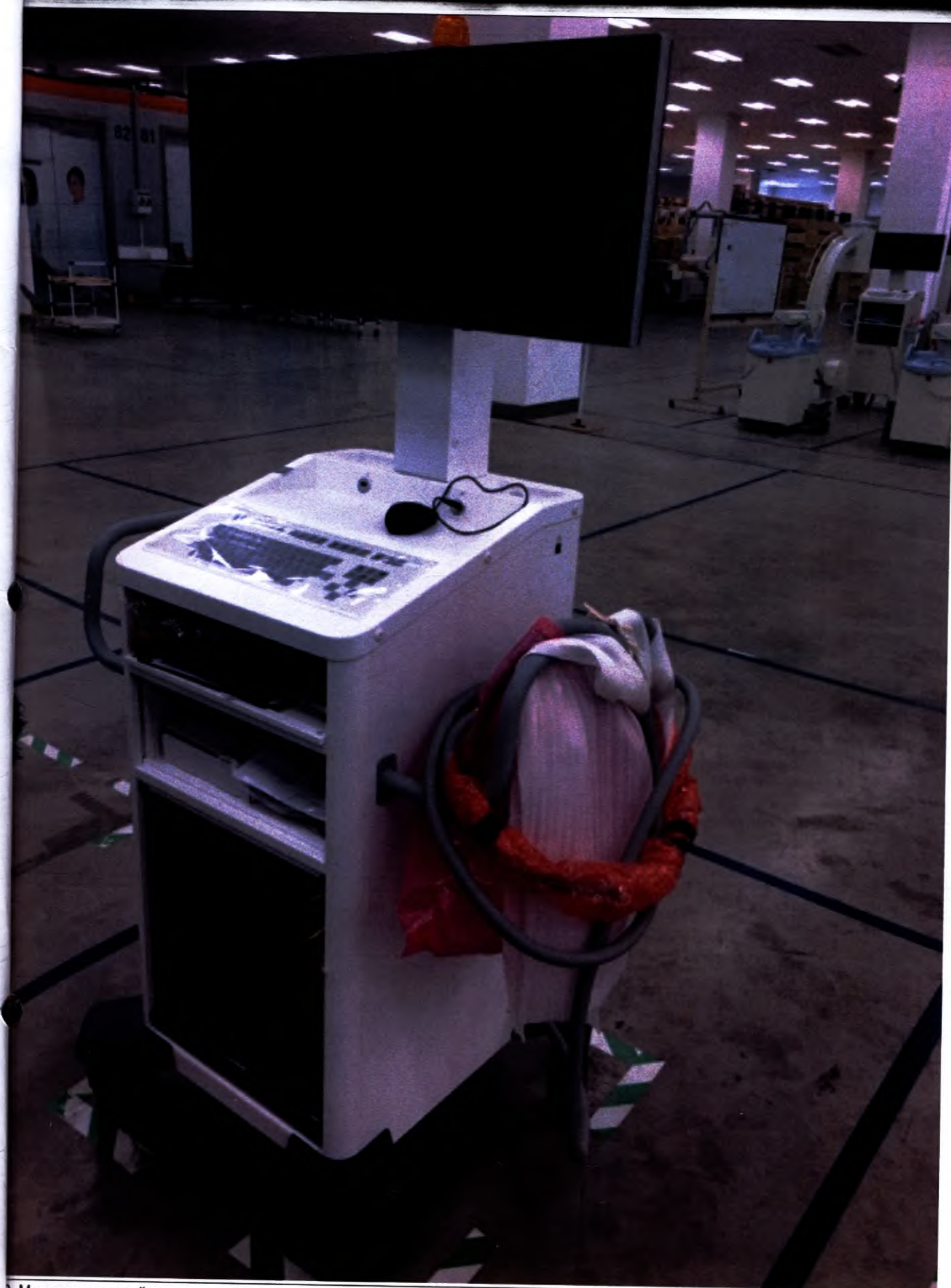
2. Мониторная стойка, в составе: панель управления с клавиатурой; мышь; порт USB; монитор, 2 шт.; дисковод для дисков DVD.
