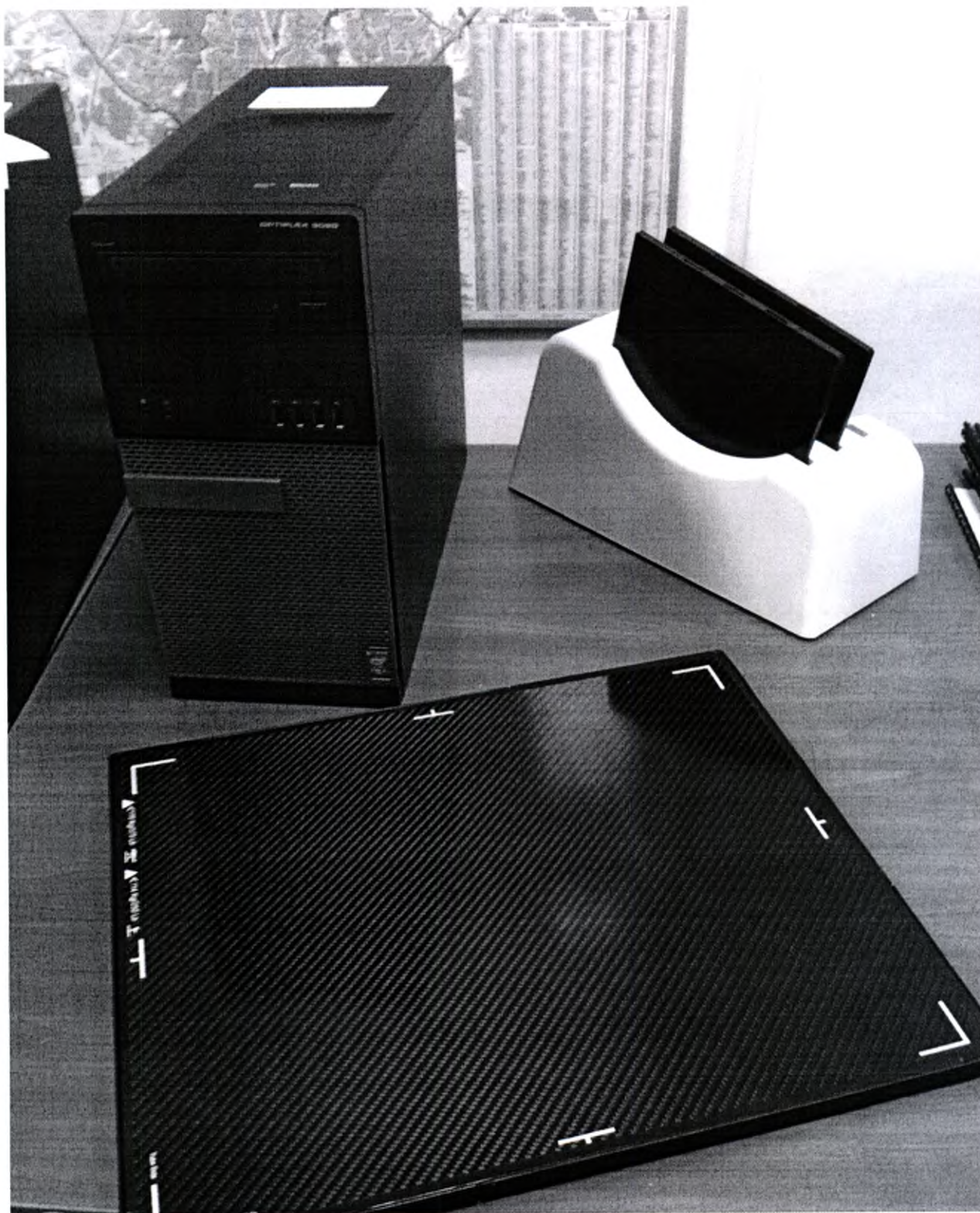
Комплекс аппаратно-программный для получения, обработки, передачи и архивирования цифровых медицинских рентгеновских изображений «ДИАРМ-МТ», производства фирмы АО «МЕДИЦИНСКИЕ ТЕХНОЛОГИИ Лтд», Россия.
