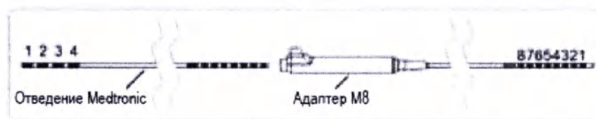
Рис. 4. Присоединение адаптера M8 Vercise
