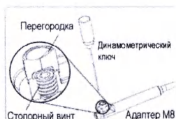
Рис. 1. Расположение стопорного винта в адаптере M8 Vercise.
