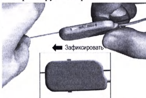
Рисунок 10. Присоединение электрода к разъему операционного кабеля
