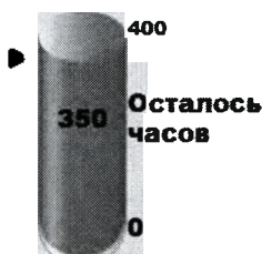
рис. 4.9. Индикатор срока эксплуатации лампы.
