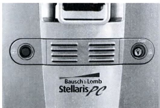
рис. 1.50. Передняя панель с кнопкой аварийной остановки лазера, вентиляционными отверстиями и выключателем с ключом.
