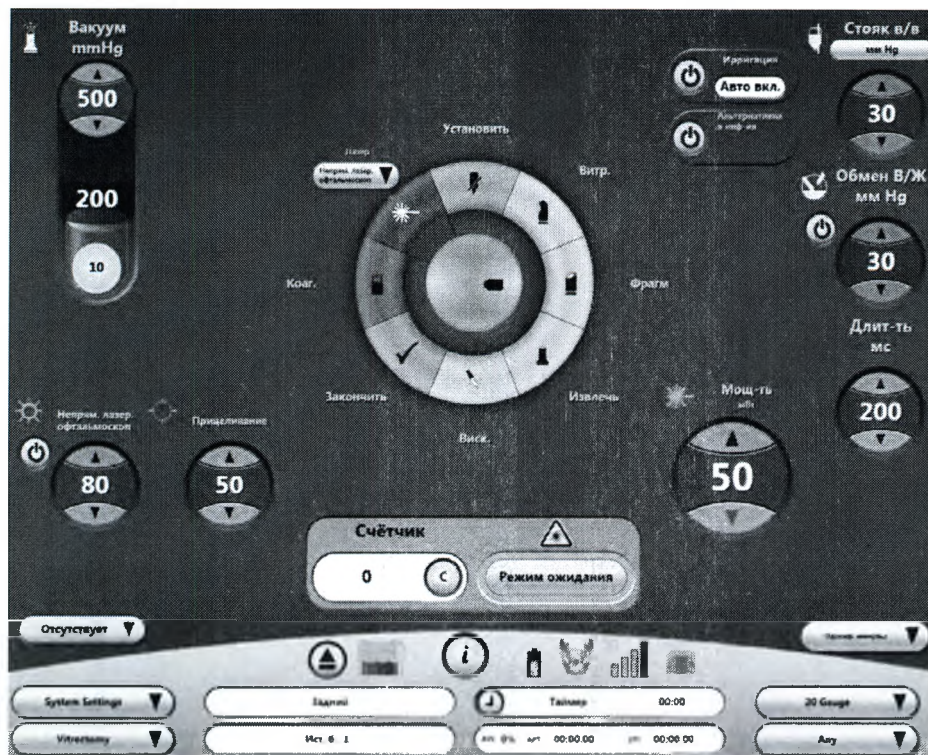
рис. 1.59. «Хирургический экран», на котором показан выбранный подрежим лазера «Непрям. лазер офтальмоскоп» и состояние лазера «Режим ожидания». Отображен элемент управления «Лампа ЛЮ», свидетельствуя о том, что устройство ЛЮ подключено.
