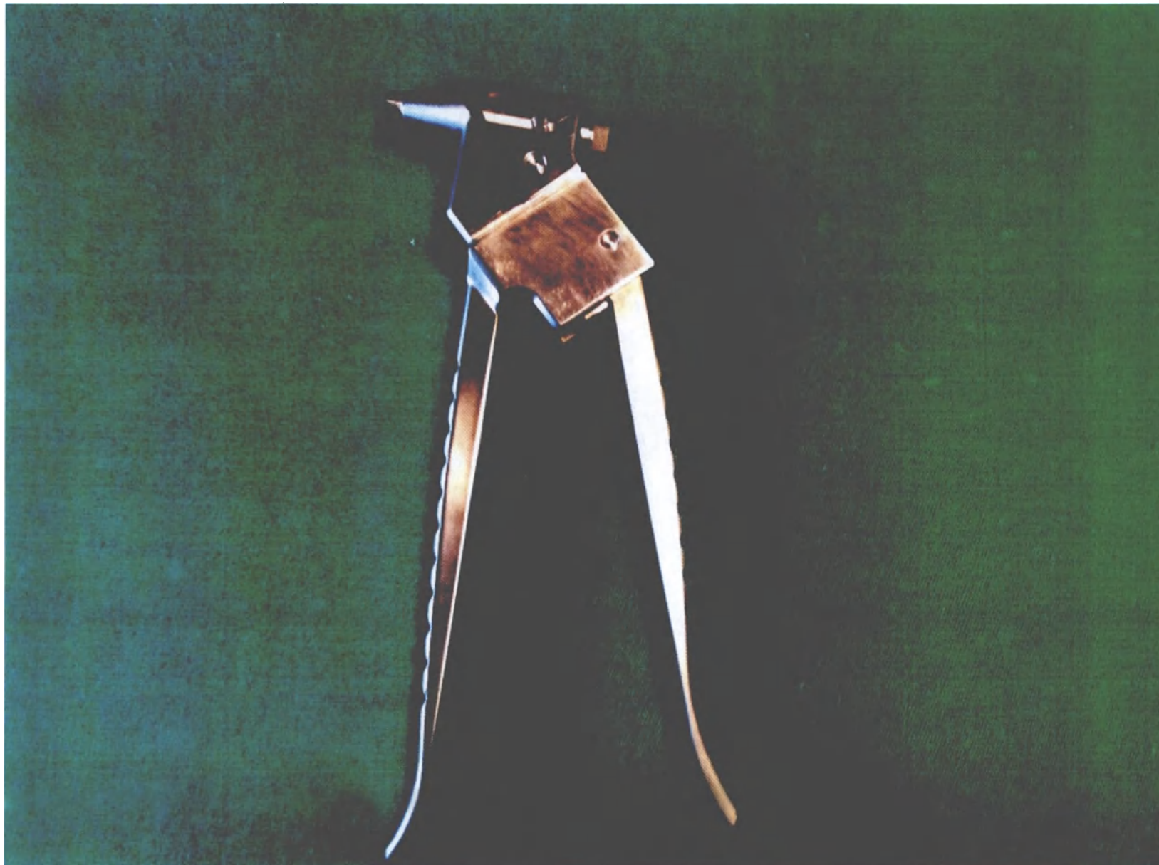
Фото 3. Инструмент для установки: аппликатор, арт. ФИКС-А
