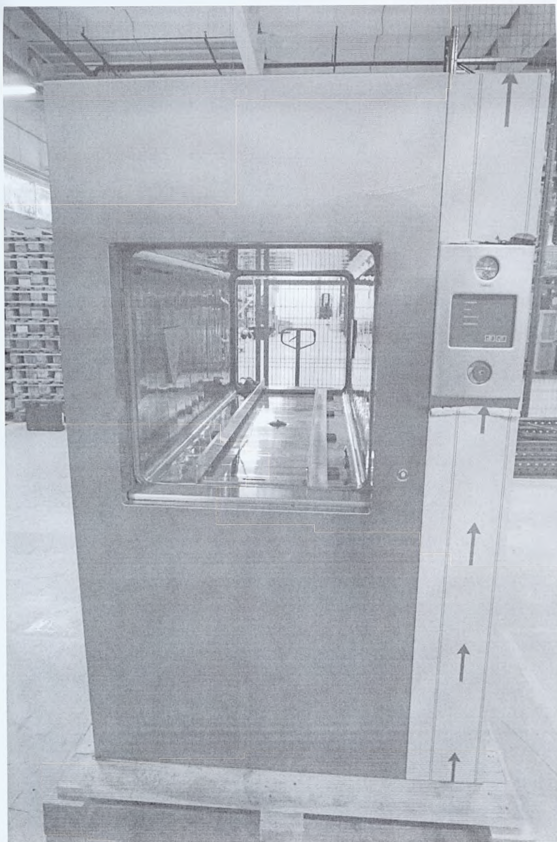
Внешний вид МИ Стерилизатор паровой с автоматическим управлением PHS (ПиЭйЭс)-800 (в упаковочной пленке)
