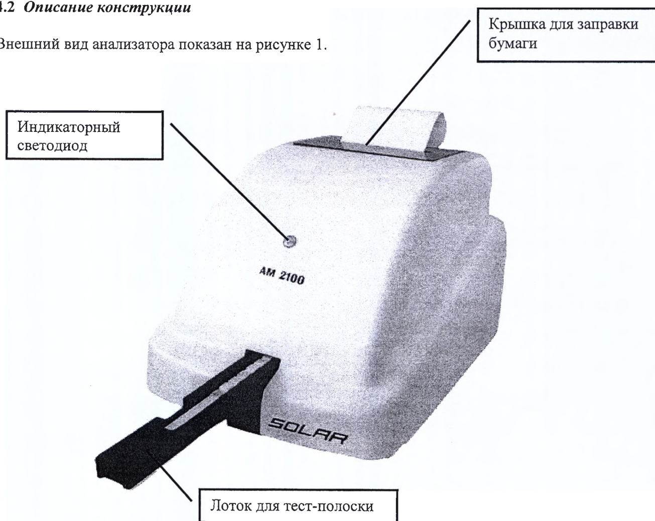
Рисунок 1 – Внешний вид анализатора мочи
