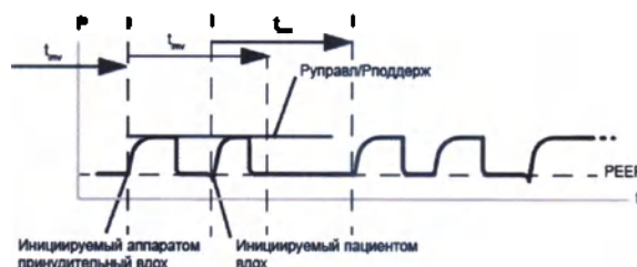
Рисунок В-24. Временные характеристики дыхательного цикла в режиме PSIMV+ IntelliSync
