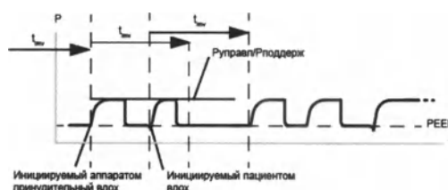
Рисунок В-26. Временные характеристики дыхательного цикла в режиме NIV-C/B
