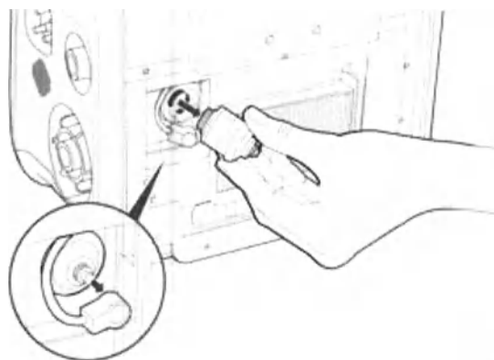
Рисунок 11-7. Замена кислородной ячейки
