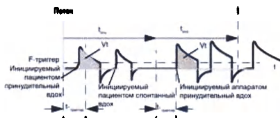
Рисунок В-17. Временные характеристики дыхательного цикла в режиме SIMV+
