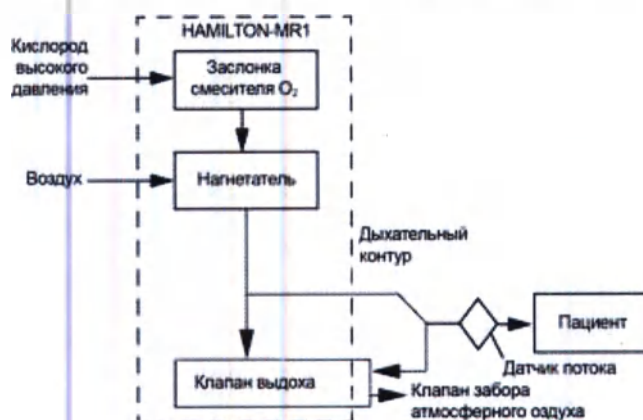
Рисунок 1-1. Подача газовой смеси к аппарату ИВЛ HAMILTON-MR1
