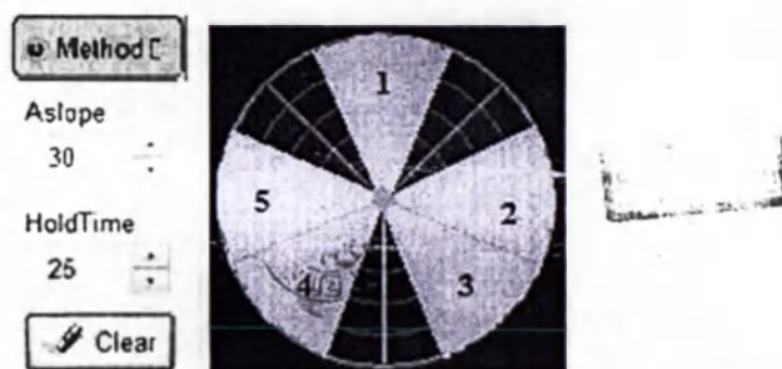
Рисунок 60 – Меню «Test» («Тестирование»). «Test Method» («Метод тестирования»). «MethodC» («Метод С»): «Aslope» («Наклон»), «HoldTime» («Время удержания»)
