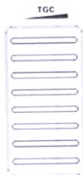
Рисунок 4.4.1 – Ползунки TGC, регулирующие компенсацию усиления по глубине
