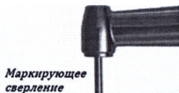
Начало сверления сверлом пилотным Ø 2,0 мм
