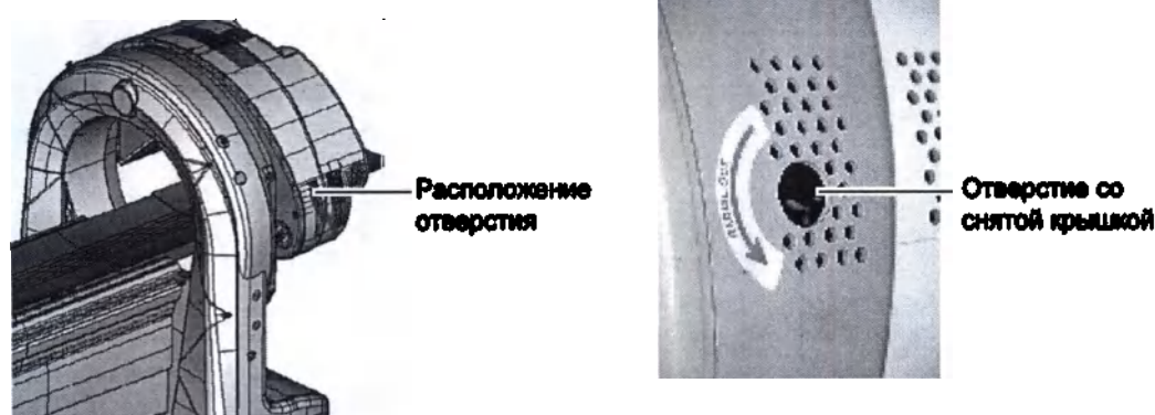
Рис. 1-5. Отверстие на гентри, в которое вставляется ручка для ручной разблокировки
