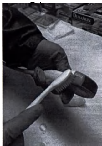
Рисунок 5-4 Чистка датчика щеткой
