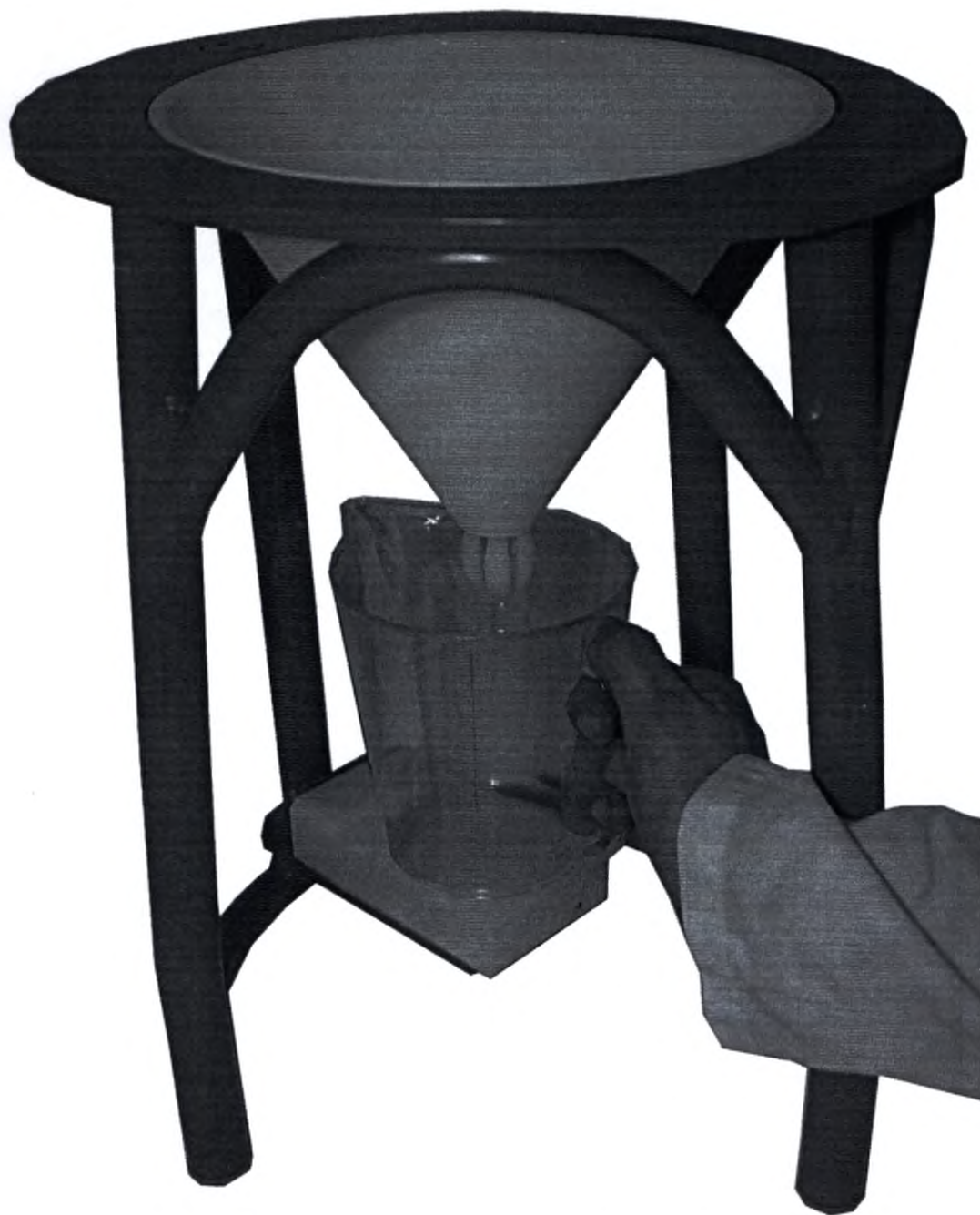
Рис. 13. Размещение мерной кружки на диск измерительного весового блока УФМ «СИГМА».
