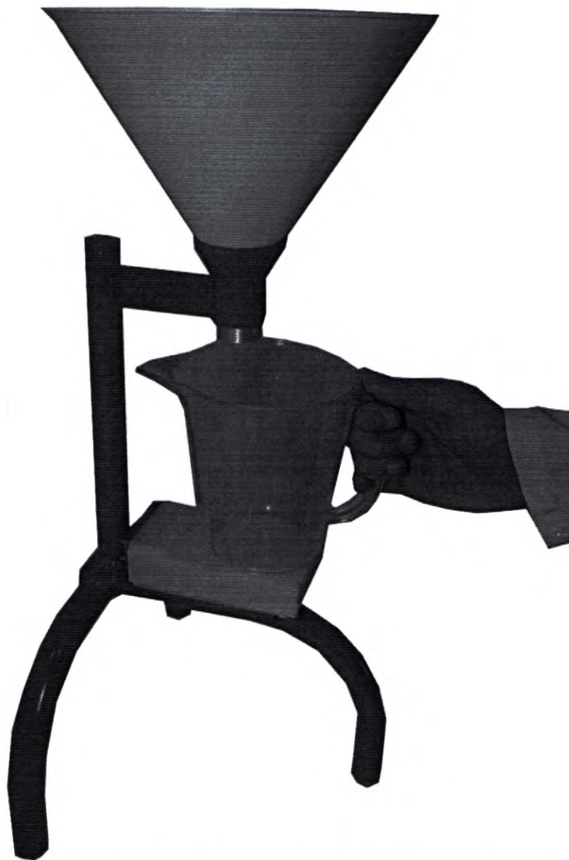
Рис. 6. Размещение мерной кружки на диск измерительного блока УФМ «СИГМА». УФМ «СИГМА» собран и готов для подключения к персональному компьютеру (Рис. 7.).
