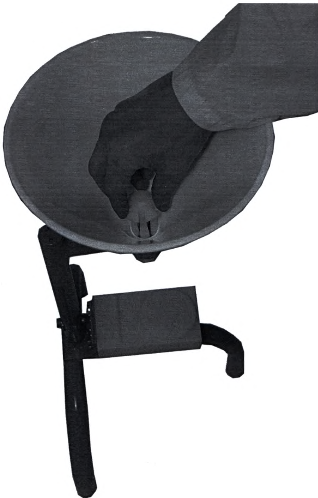
Рис. 5. Установка воронки на корпус УФМ «СИГМА». Разместить мерную кружку на датчиковой коробке таким образом, чтобы кантик, находящийся на днище кружки совпадал с диском измерительного блока УФМ «СИГМА» (Рис. 16.).
