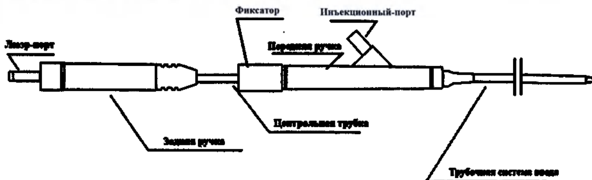
Рисунок 3 – Система доставки под проводник
