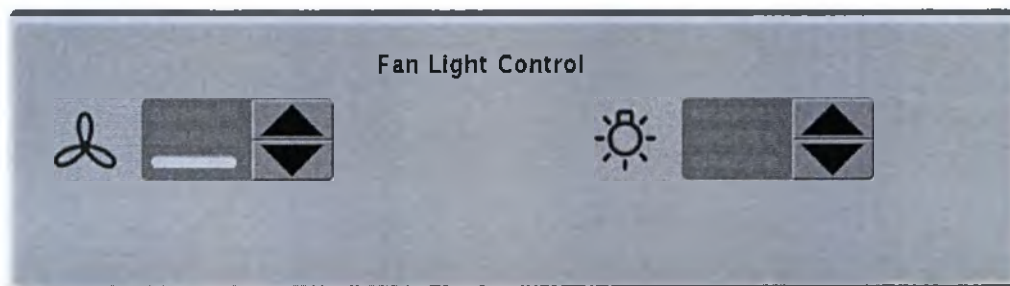
Рисунок 3-72: Область управления вентилятором и освещением на экране управления синхронизацией, вентилятор на низком уровне и освещение выключено
