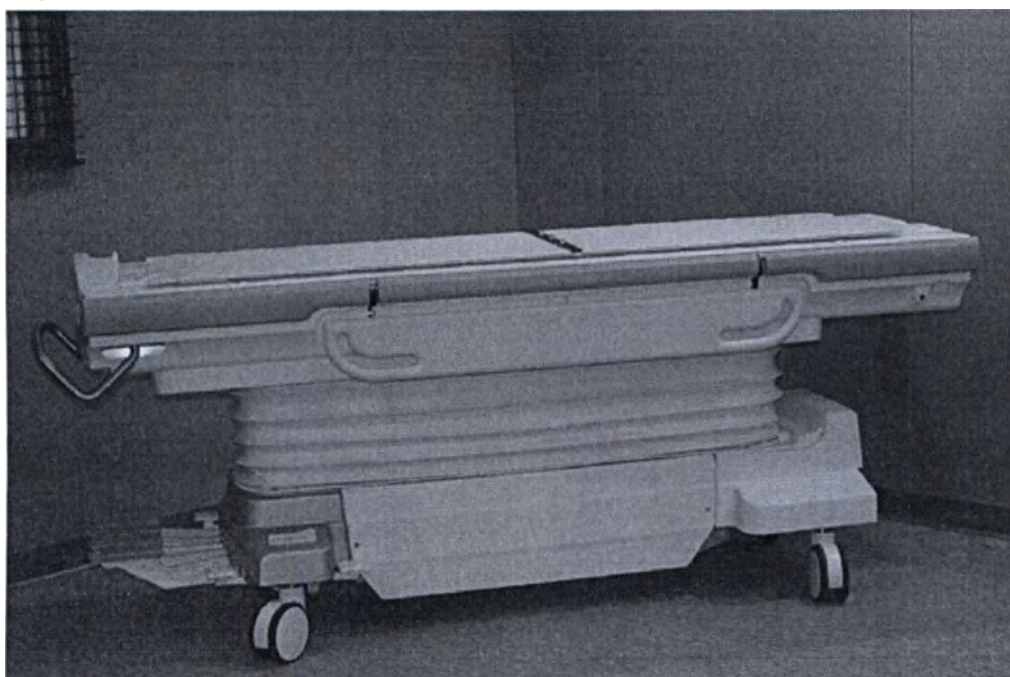
Рисунок 3-205: Стол GEM для МРТ с установленной на нем вставкой для радиационной онкологии.
