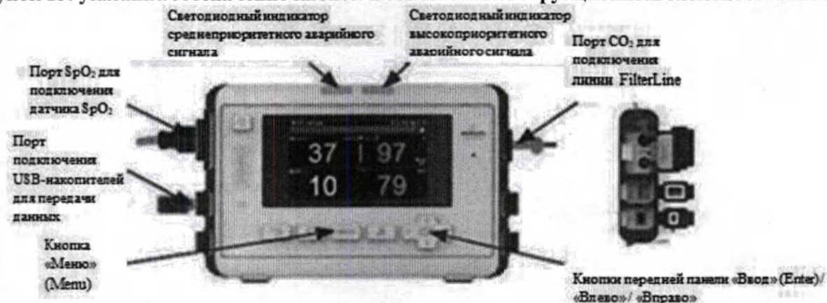
Рисунок 15: указание/обозначение кнопок и соновных конструкционных элементов монитора
