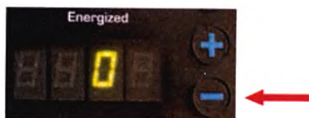
Рис. 16. Синяя кнопка "-" уменьшения мощности режимов коагуляции Coagulation Mode .
