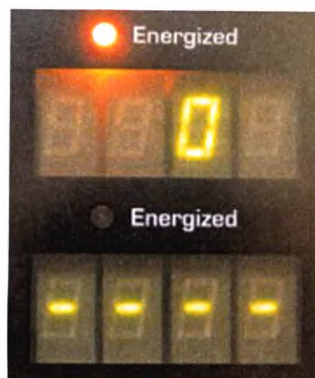
Рис. 17. Желтый индикатор активации режимов разреза Cutting Mode – Energized ("Под напряжением"). Цифровой дисплей значений мощности для режимов разреза Cutting Mode (Вверху).
