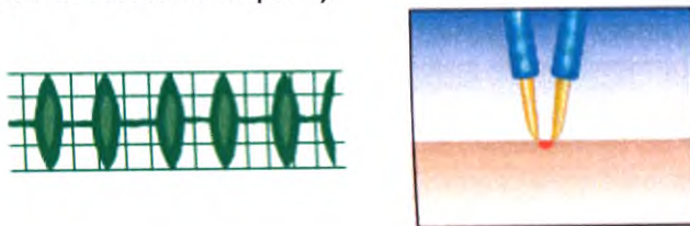
Рис. 37. Режим BIPOLAR ("БИПОЛЯРНАЯ КОАГУЛЯЦИЯ"). Частично выпрямленная форма радиочастотной волны (слева). Биполярная коагуляция биполярным пинцетообразным электродом (справа).
