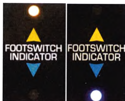
Рис. 10. Активирована ножная педаль режимов разреза Cutting Mode (слева). Активирована ножная педаль режимов коагуляции Coagulation Mode (справа).
