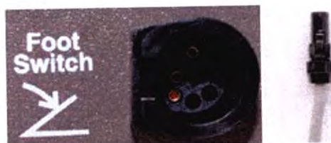
Рис. 24. Гнездо для подключения ножной педали (слева). Штекер шнура ножной педали (справа).
