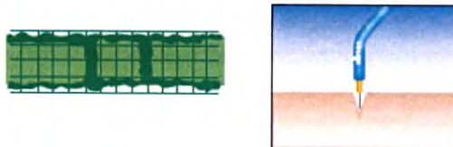
Рис. 30. Режим Pellevé/CUT ("Пеллеве/РАЗРЕЗ"). Полностью выпрямленная фильтрованная форма радиочастотной волны (слева). Схематическое изображение режима: нет бокового повреждения (справа).
