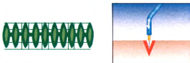
Рис. 34. Режим BLEND ("СМЕСЬ"). Полностью выпрямленная форма радиочастотной волны (слева). Схематическое изображение режима: имеется коагуляционная пленка (справа).
