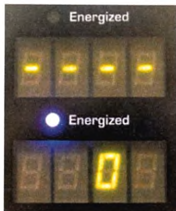
Рис. 18. Синий индикатор активации режимов разреза коагуляции Coagulation Mode - Energized ("Под напряжением"). Цифровой дисплей значений мощности для режимов коагуляции Coagulation Mode (Внизу).
