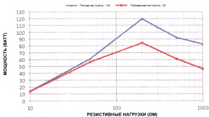
Отношение выходной мощности к резистивной нагрузке в режиме Биполярная коагуляция
