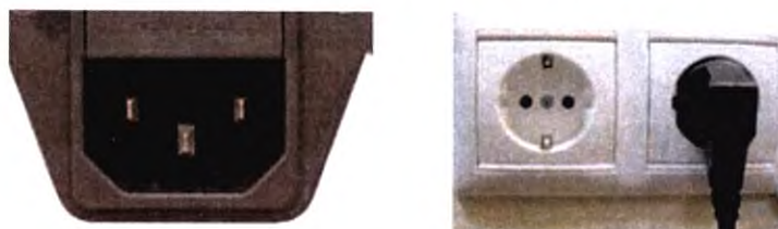
Рис. 21. Гнездо для подключения сетевого шнура (слева). Подключение аппарата в сеть (справа).
