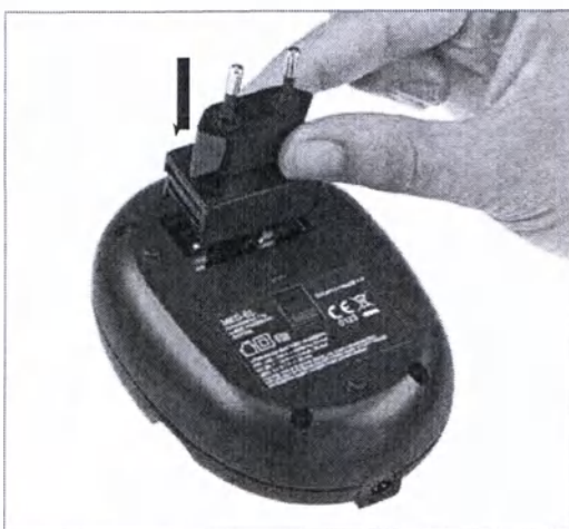
Рис. 12 Вставьте адаптер в углубление в задней части зарядного устройства
