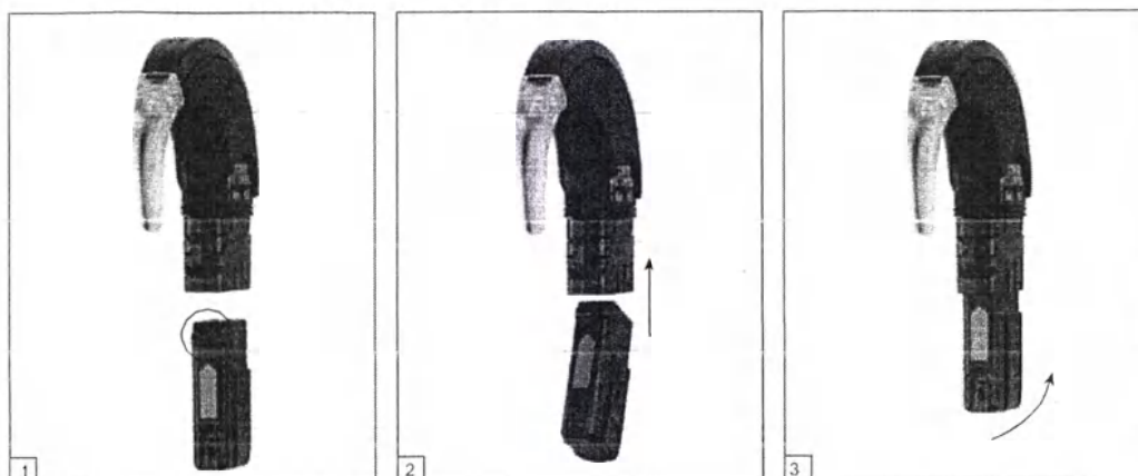
Рис. 11 Вставка SONNET аккумулятора в SONNET адаптер аккумулятора
