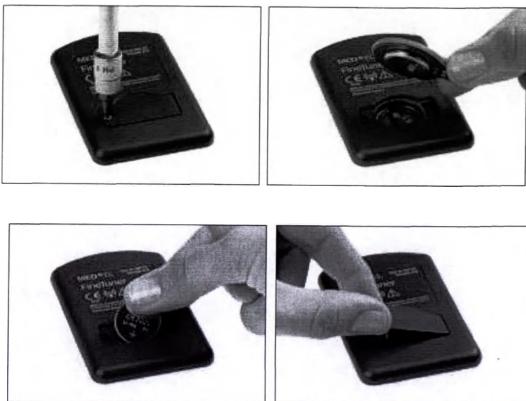
Рис. 24 Замена батареи в пульте дистанционного управления FineTuner
