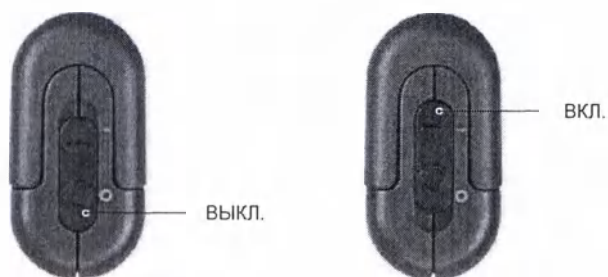
Рис. 11 Переключатель ВКЛ./ВЫКЛ. (блокировка батарейного отсека)
