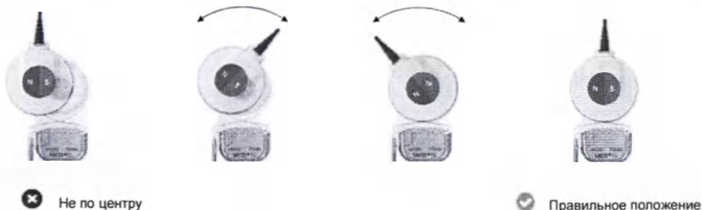
Рис. 9 Совмещение магнитов передатчика и импланта
