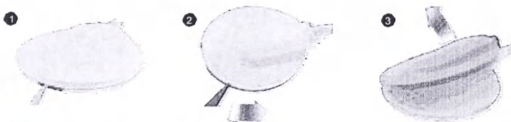
Рис. 18 Снятие крышки передатчика типа DL
