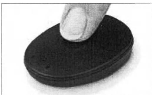
Рис. 2. Включение и выключение аудиопроцессора
