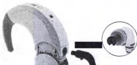
Рис. 25 Подключение SONNET кабеля передатчика к SONNET 2 блоку процессора
