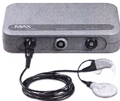
Рис. 16 Подключение аудиопроцессора OPUS 2 к MAX Программному интерфейсу
