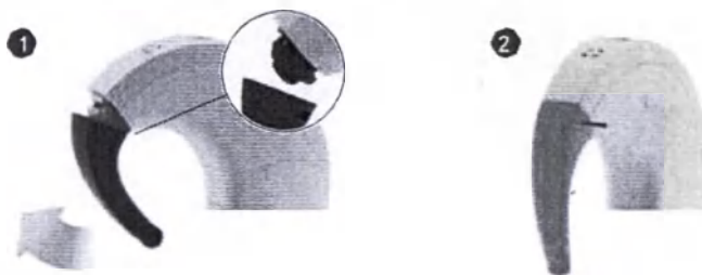
Рис. 29 Отсоединение SONNET заушины
