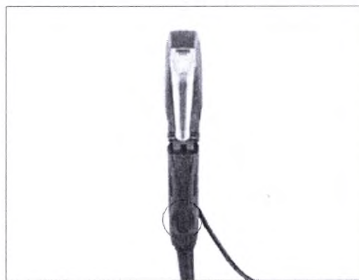
Рис. 14 Отсоединение MAX кабеля для программирования SONNET/ SONNET 2
