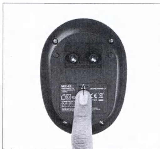
Рис. 13 Сдвиньте защелку, чтобы извлечь адаптер
