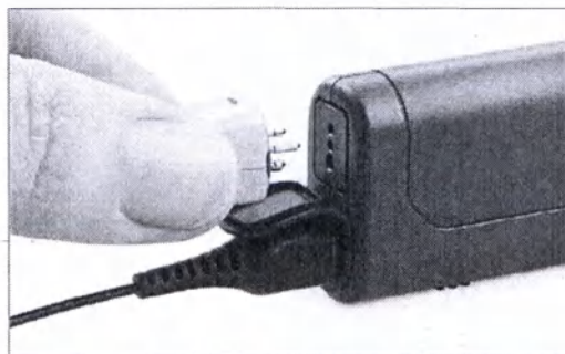
Рис. 17 Подключение FM-систем прямого соединения к гнезду EA миниатюрного блока элементов питания
