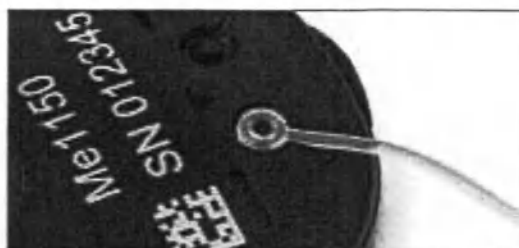
Рис. 13. Фиксация крепления к корпусу аудиопроцессора
