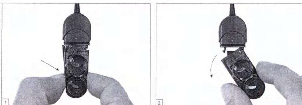
Рис. 8 Отсоединение SONNET ActiveWear соединительного кабеля от SONNET блока элементов питания
