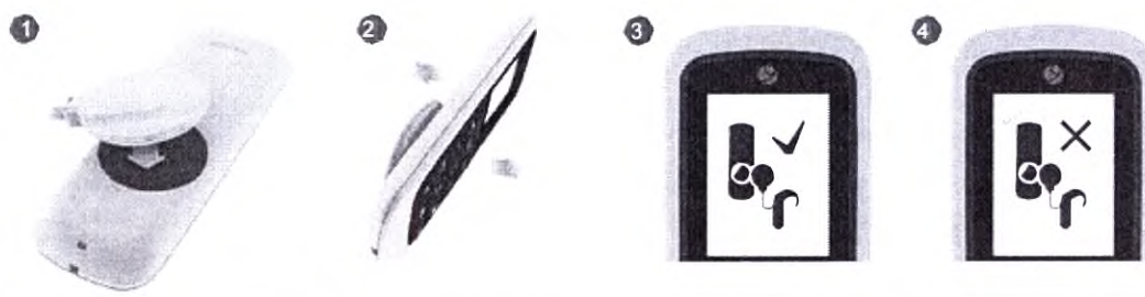
Рис. 4 Сопряжение FineTuner Echo с аудиопроцессором
