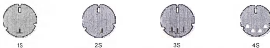
Рис. 8. Варианты силы притяжения магнитов для имплантата SYNCHRONY (RONDO 2 магнит S)
