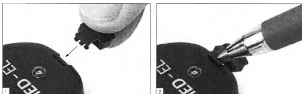
Рис. 15. Повторное крепление затвора разъема
