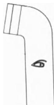
Рис. 18 - Эскиз метки для уровня глаза на металлической раме
