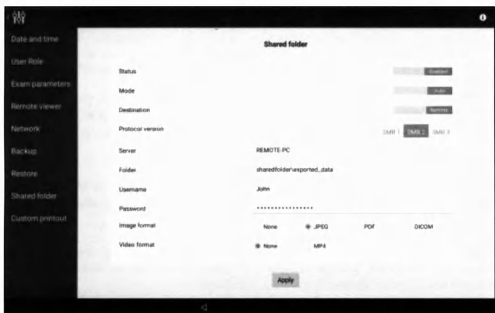
Рис. 87 - Configurator – пример конфигурации общей папки: автоматический экспорт изображений JPEG и MP4-видео в удаленную папку exported_data (вложенная папка sharedfolder ), расположенную на сервере REMOTE-PC , с именем пользователя сервера John
