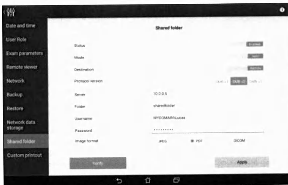
Рис. 93 - Configurator – Пример конфигурации общей папки в сетях Windows Domain: автоматический экспорт распечаток PDF по протоколу SMB2 в удаленную папку sharedfolder , расположенную на сервере с IP-адресом 10.0.0.5 , с именем пользователя домена Lukas и именем домена MYDOMAIN
