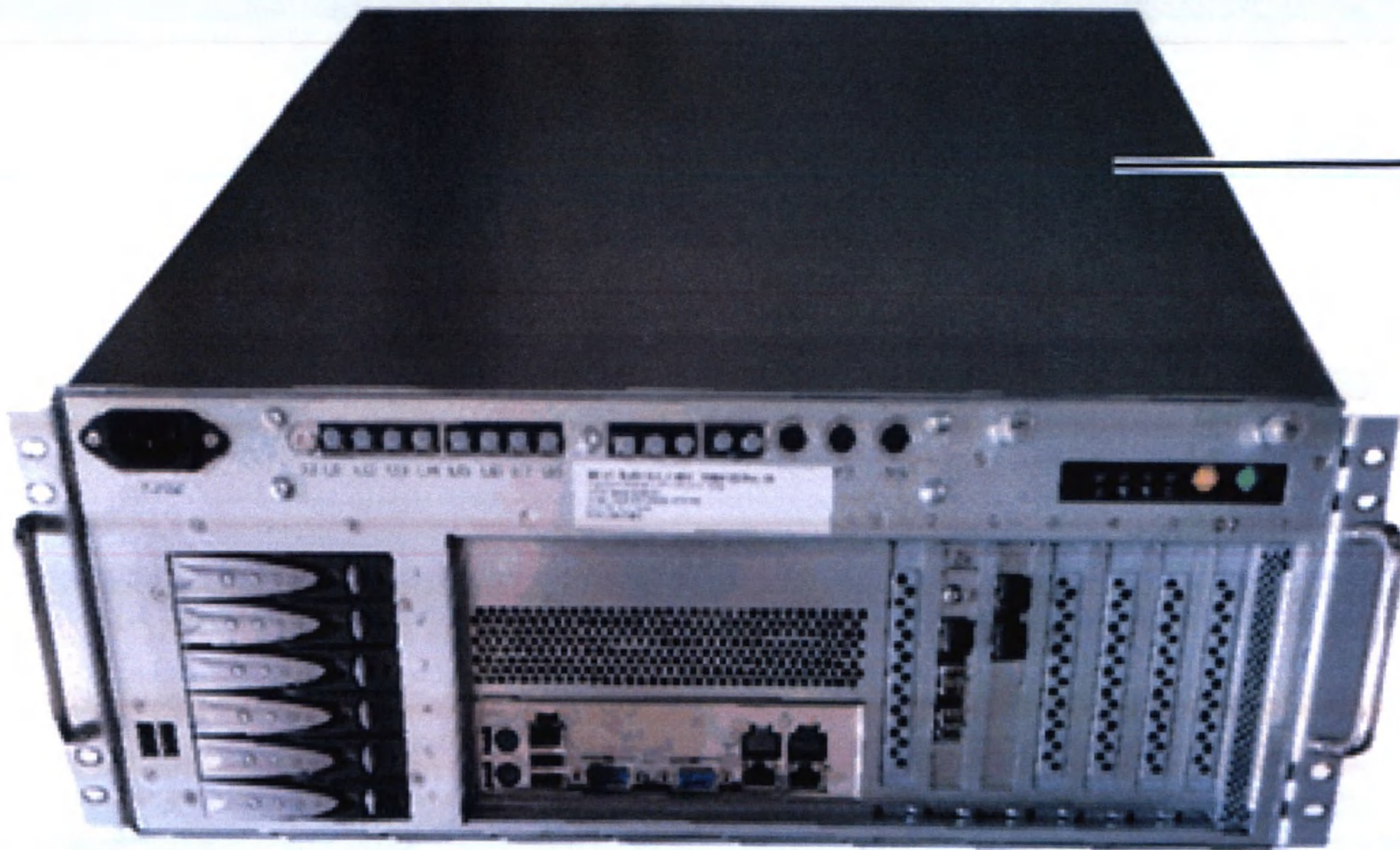
26. Компьютерный блок реконструкции изображений
