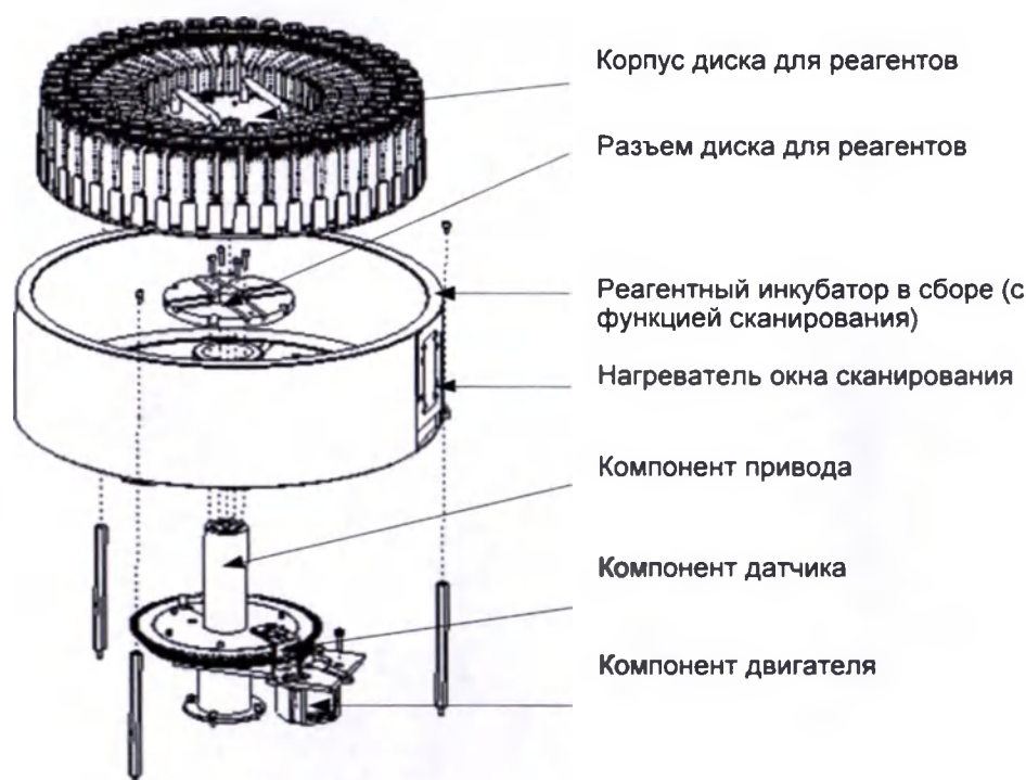
Рисунок 7-12 Конструкция компонента диска реагентов
