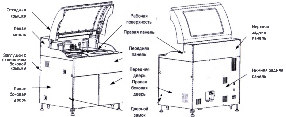
Рисунок 7-5 Схематическое представление конструкции корпуса устройства
