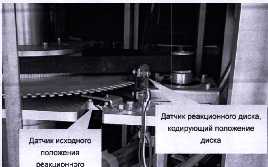
Фиксация датчика реакционного диска
