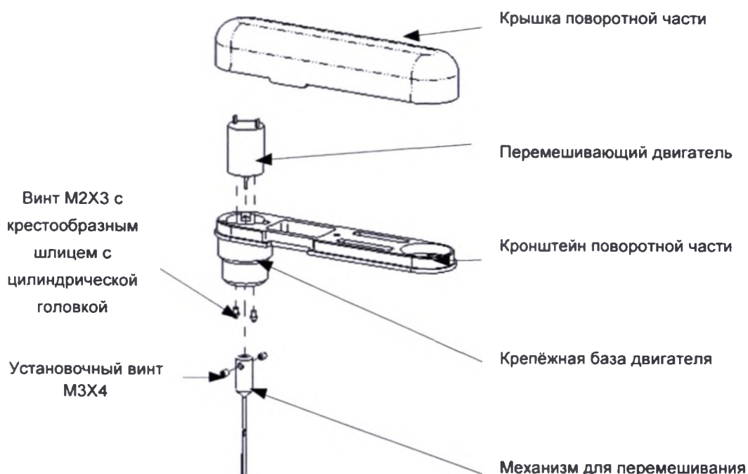
Рисунок 7-28 Конструкция компонента перемешивающей поворотной части
