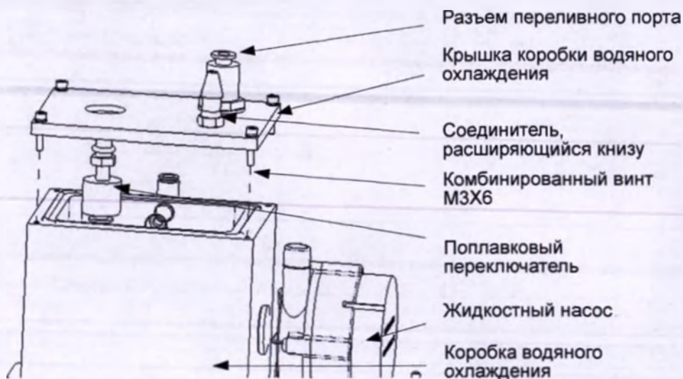
Рисунок 7-38 Конструкция коробки водяного охлаждения
