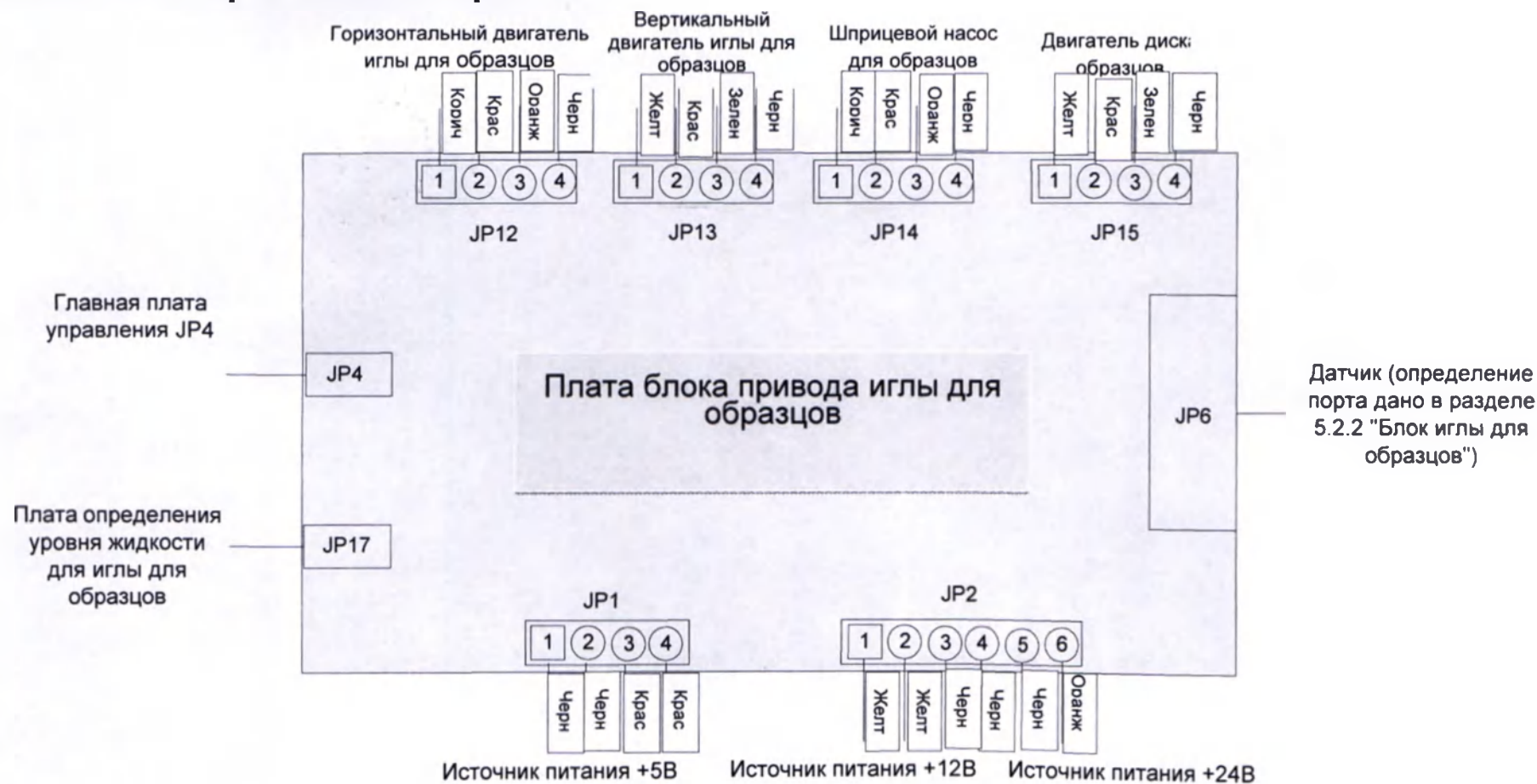
Схема проводки блока иглы для образцов
