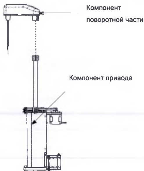
Рисунок 7-23 Конструкция движущегося компонента иглы для реагентов
