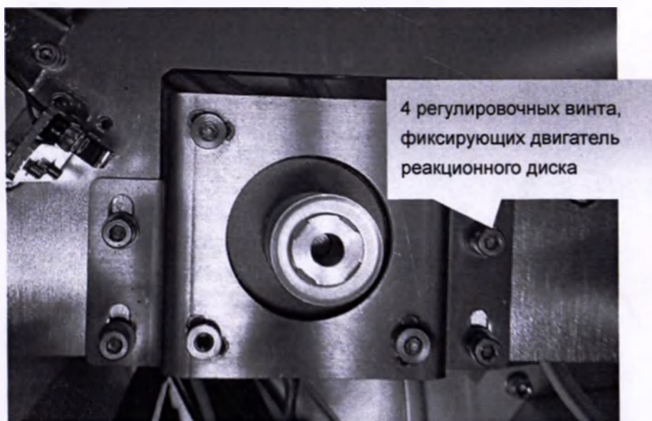
Фиксация двигателя реакционного диска
