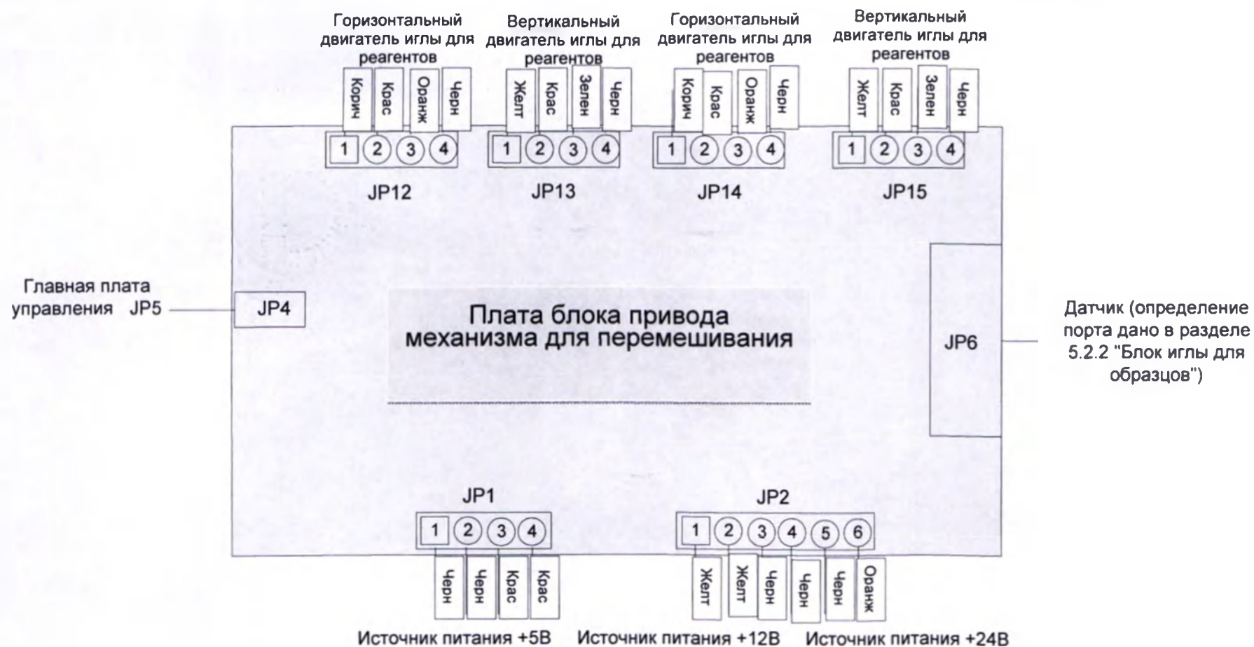
Схема проводки блока механизма для перемешивания
