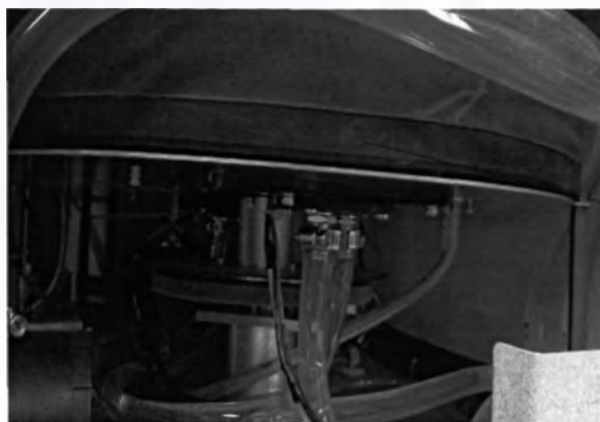
Рисунок 6-4 Охлаждение диска реагентов
