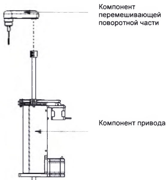
Рисунок 7-25 Конструкция компонента перемешивания образцов
