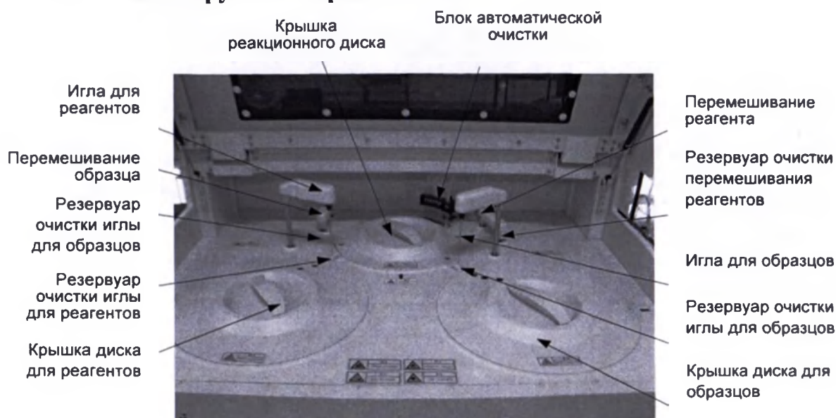
Рисунок 7-2 Конструкция Верхней части
