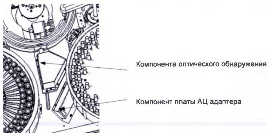
Рисунок 7-32 Конструкция оптического компонента
