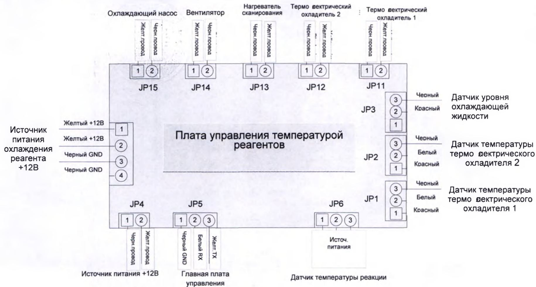
Схема проводки платы управления температурой реагентов
