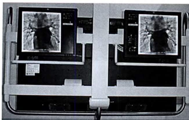
Рисунок 189 Резервные мониторы прикреплены к обратной стороне большого экранного монитора.
