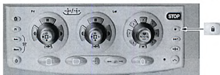
Рисунок 10 Панель управления на краю стола (TSSC) для систем Innova IGS 6 со столом Omega
