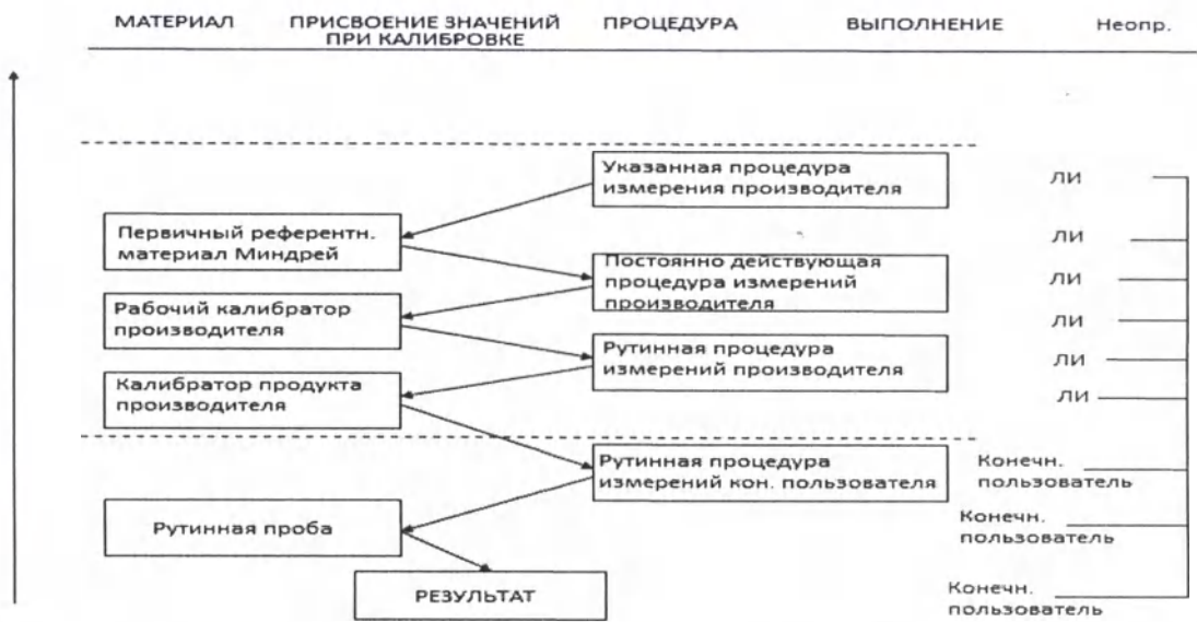
Рисунок 6. Иерархия калибровки и прослеживаемость для выбранной производителем методики выполнения измерений
