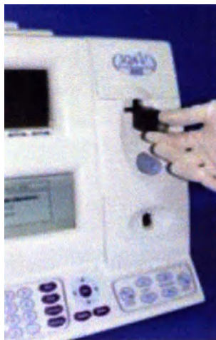
Рис. 55. Установка держателя слайдов
