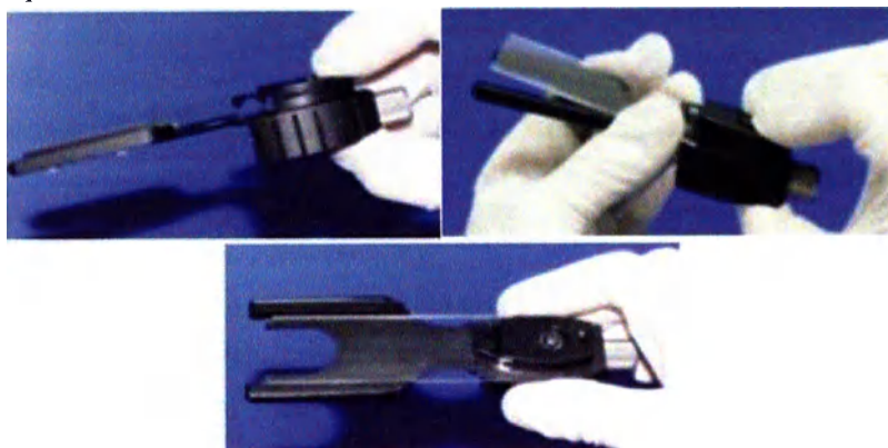
Рис.54. Помещение слайда в держатель
