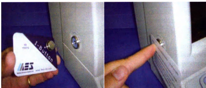
Рис. 56. Установка нового I-Button
