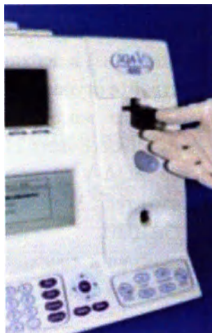
Рис. 55. Установка держателя слайдов
