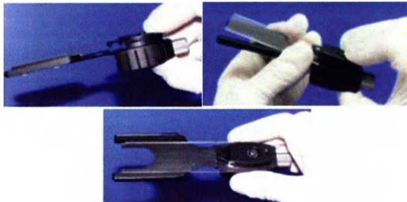
Рис.54. Помещение слайда в держатель
