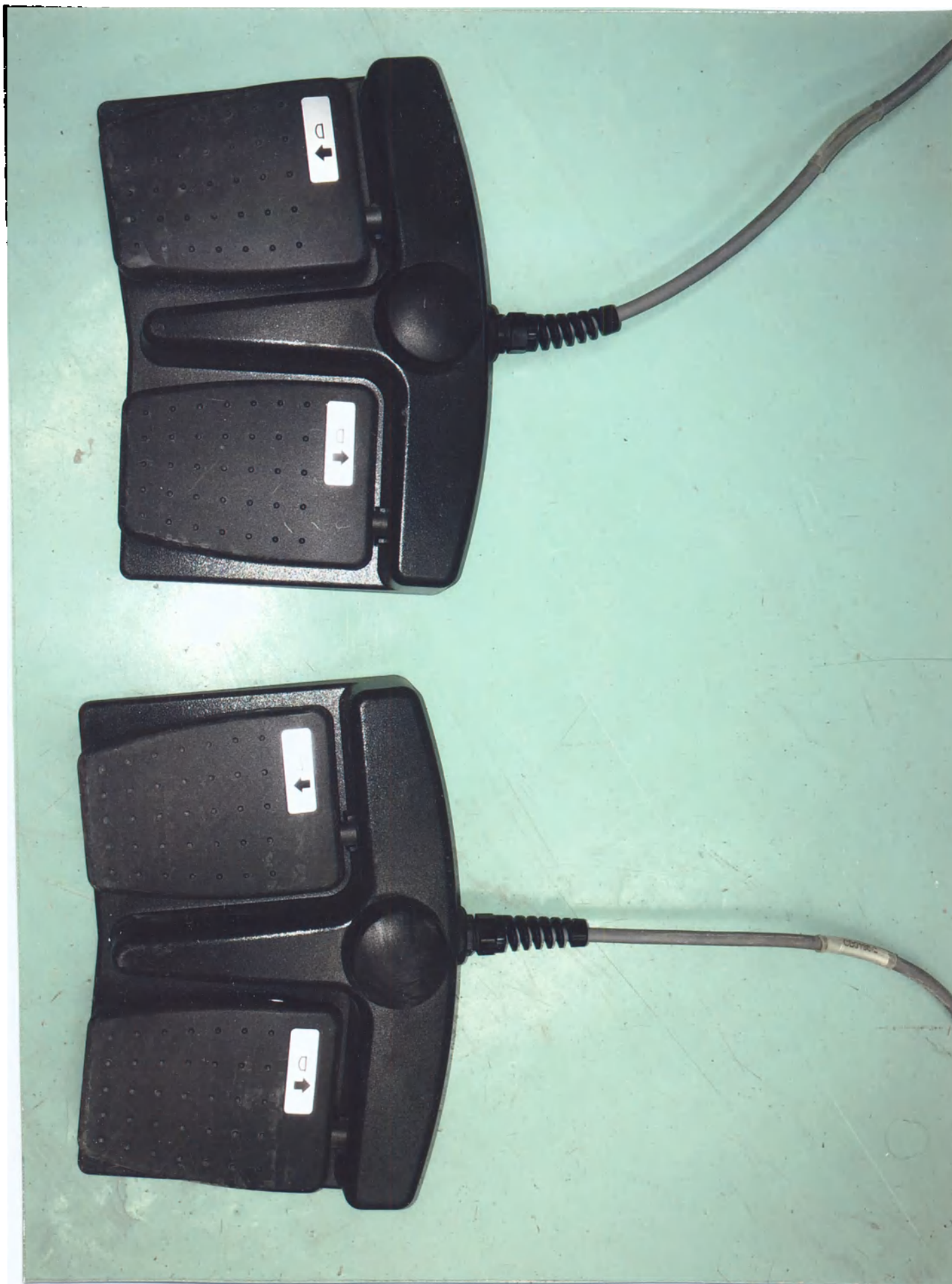
10. Блок педалей компресії та декомпресії ТМО.00А.8043 виробництва АО «НІІЕМ» или виробництва Metaltronica S.p.A
