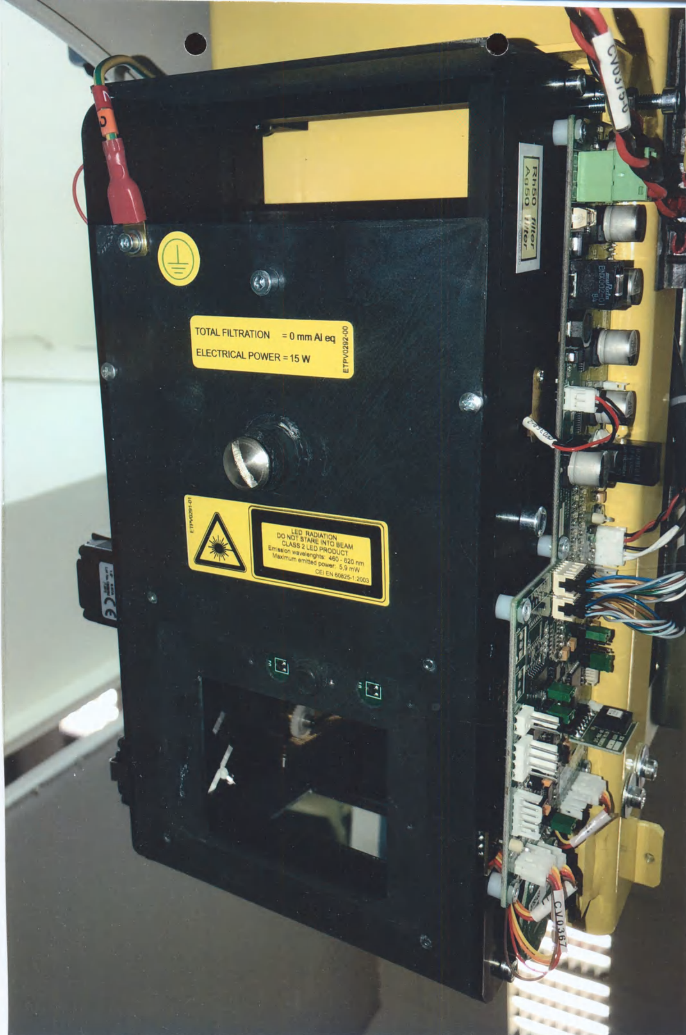
9. Коллиматор с автоматическим устройством смены фильтров (Rh/Ag), производства Metaltronica S.p.A, Италия
