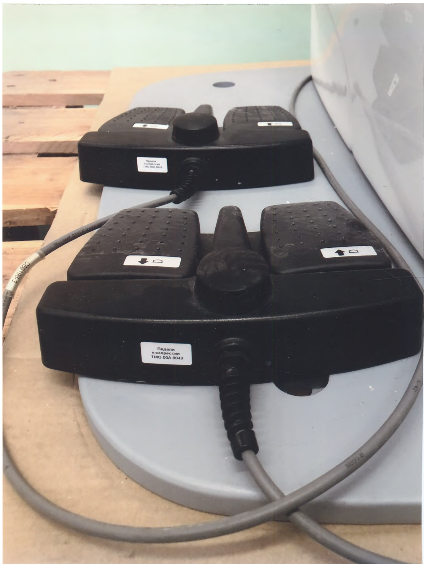
Блок педалей компрессии и декомпрессии ТМО.00А.8043 производства АО «НИИЭМ» или производства Metaltronica S.p.A
