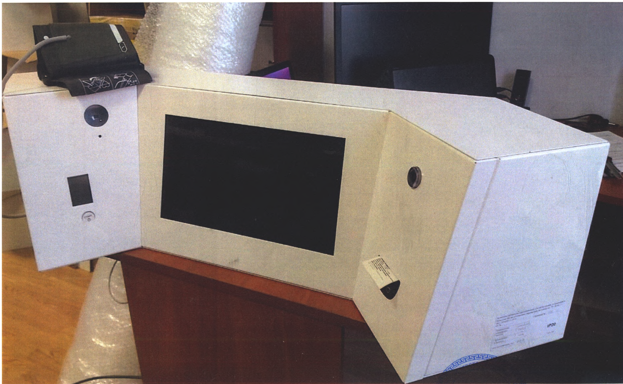
Фотографическое изображение 1. Комплекс аппаратно-программный для регистрации, сохранения и передачи физиологических параметров человека по ТУ 26.60.12-001-26540932-2019
