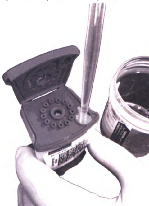
Рисунок 5. Внесение деконтаминированной разжиженной пробы в камеру для пробы картриджа
