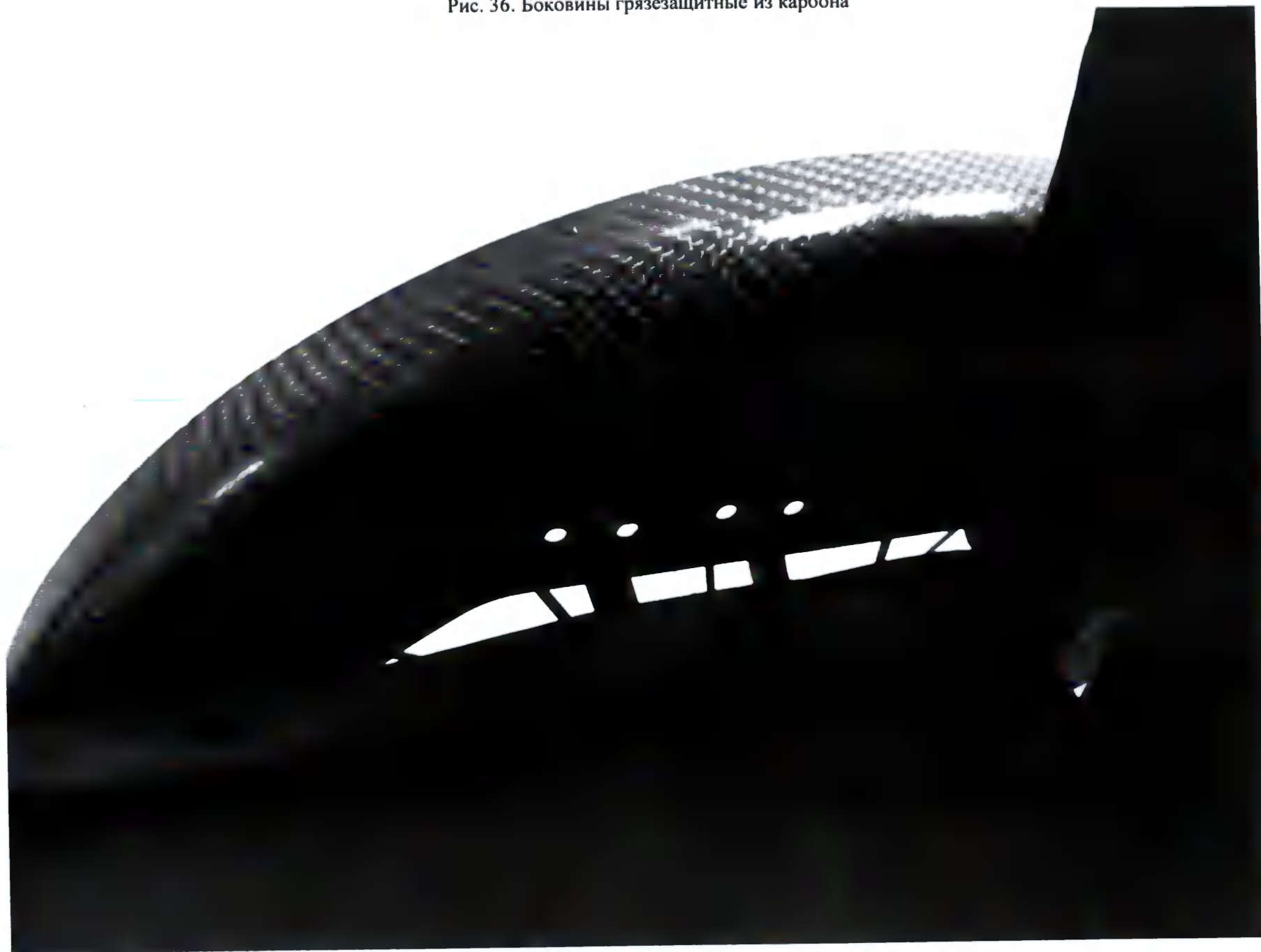
Рис. 36. Боковины грязезащитные из карбона
