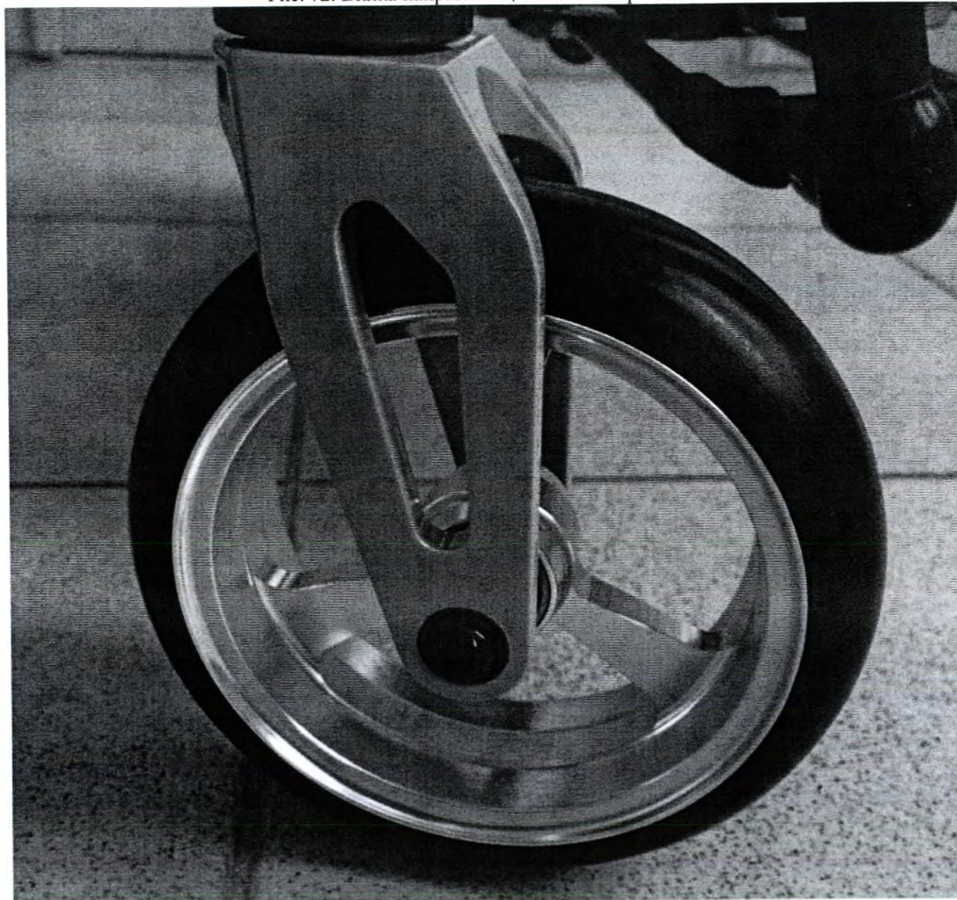
Рис. 72. Вилка направляющего колеса с резьбой
