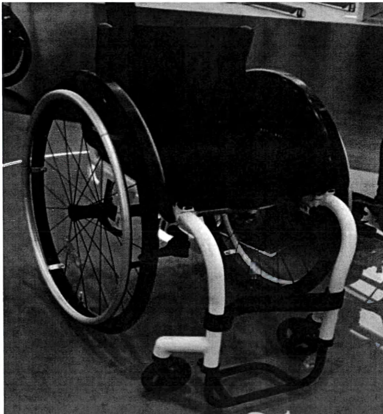
Рис. 3. Рама кресла-коляски алюминиевая/карбоновая с сужением 2 см
