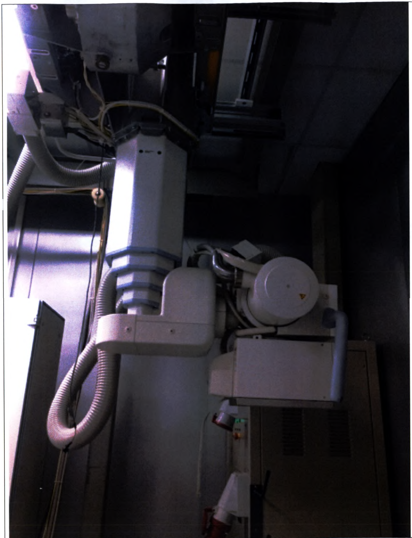
2. Полностью синхронизированный потолочный 3D - штатив с рентгеновской трубкой
