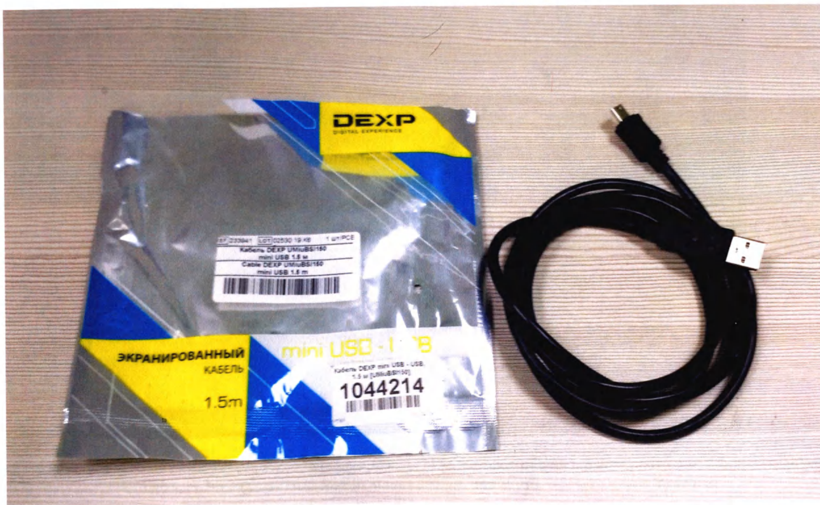
Кабель USB, разъем USB тип A (male), разъем mini USB тип B (male), длина от 1,5 до 3 м, сечение провода не менее 24AWG/2C+28AWG/1P, торговая марка DEXP UMiuBSI150 mini USB 2.0 (Shenzhen He Tai Sheng Electronics Co., Ltd., Китай) 1.5м
