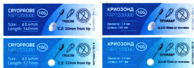
Рисунок 3: Маркировка 3 – Дополнительная маркировка внешней упаковки криозонда (формы ледяного шара сферическая или эллиптическая, тип наконечника - троакар, диаметр 2.4 или 3.4 мм, длина 124, 127, 134, 140, 180 или 185 мм)
