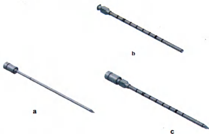
Рисунок 43: Схематичное изображение интродьюсера: (a) внешняя часть (канюля); (b) внутренняя часть (сердечник); (c) интродьюсер в собранном виде (сердечник находится внутри канюли)
