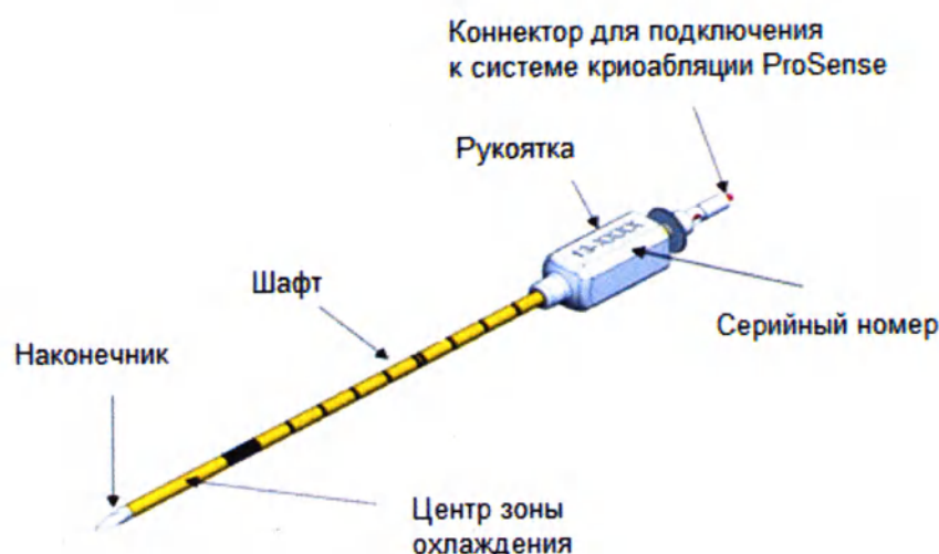
Рисунок 41: Компоненты криозонда (рисунок показан только для иллюстрации)
