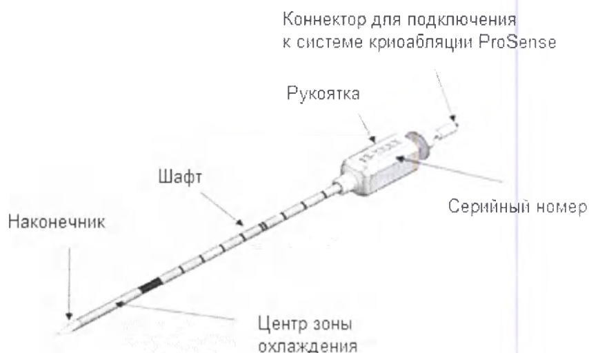
Рисунок 28: Компоненты криозонда (рисунок показан только для иллюстрации)
