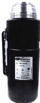
Рисунок 36: Сосуд Дьюара для жидкого азота (объемом 2 л.)
