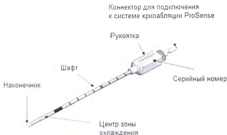
Рисунок 15: Компоненты криозонда (рисунок показан только для иллюстрации)
