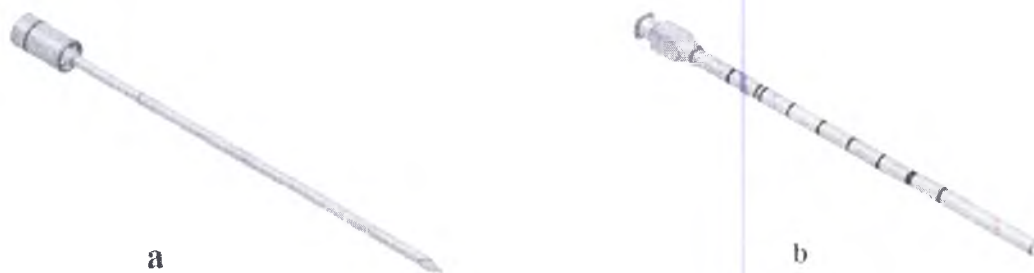
Рисунок 25. Интродьюсер: (a) внутренняя часть (сердечник); (b) внешняя часть (канюля)
