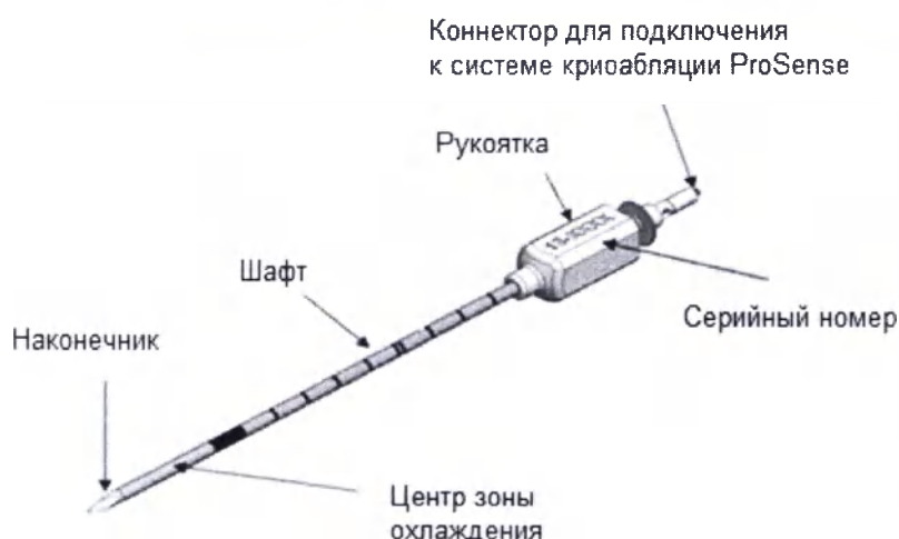
Рисунок 63: Компоненты криозонда (рисунок показан только для иллюстрации)
