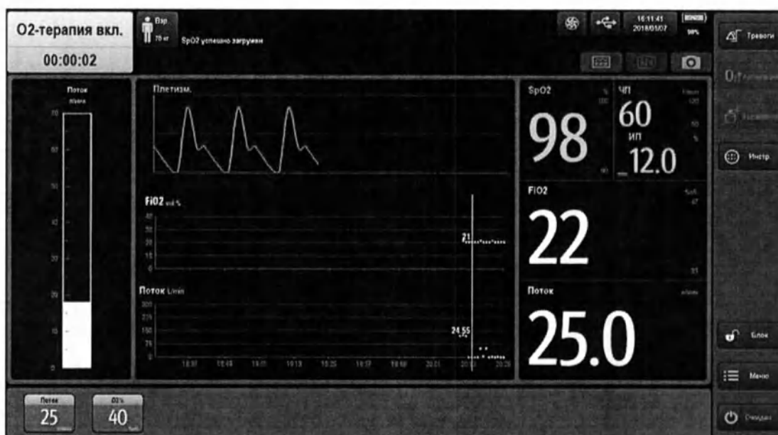
Зависимость между задаваемым максимальным значением O 2 % и потоком в режиме O 2 -терапии
