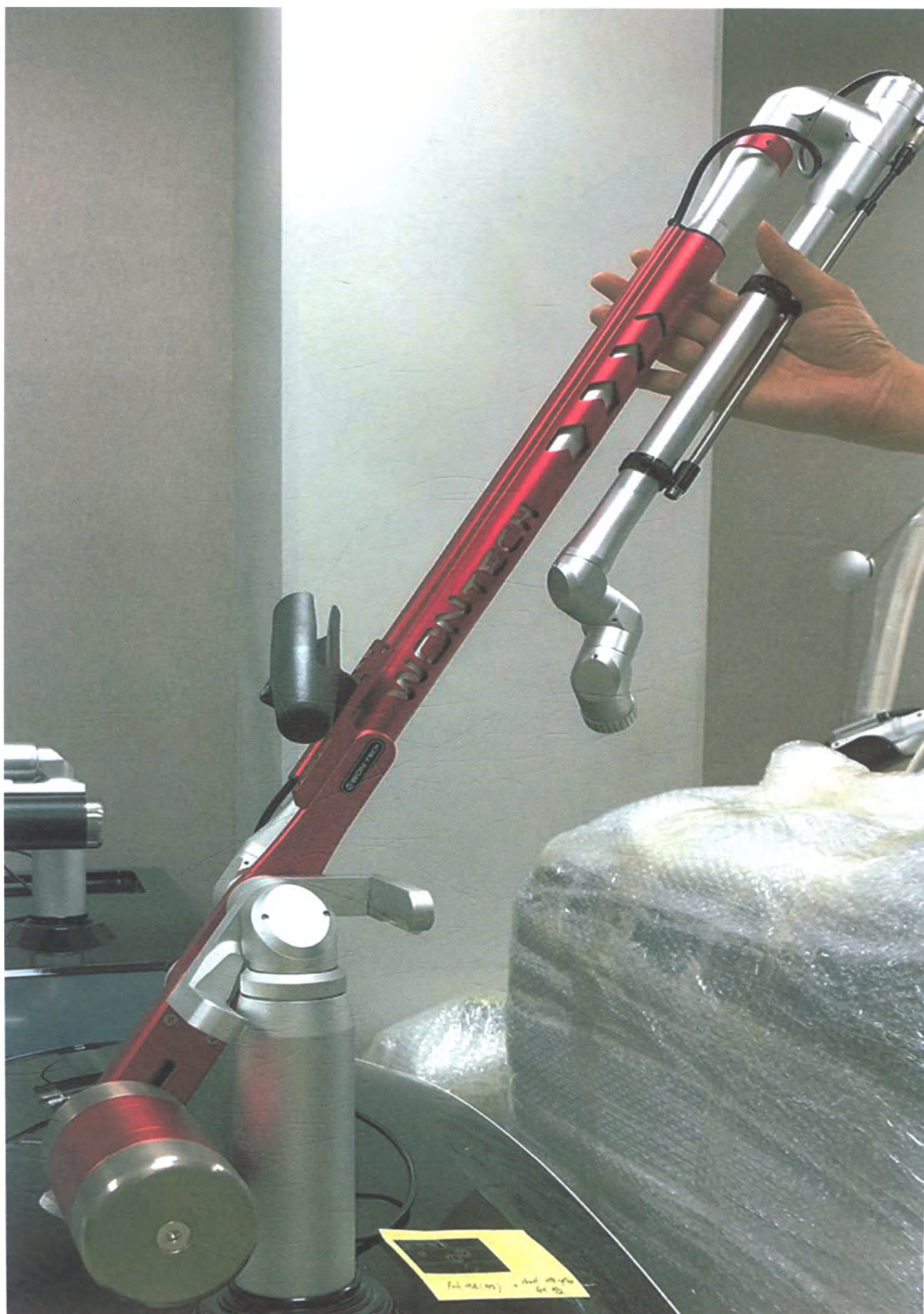
Зеркальный шарнирный манипулятор с противовесом
