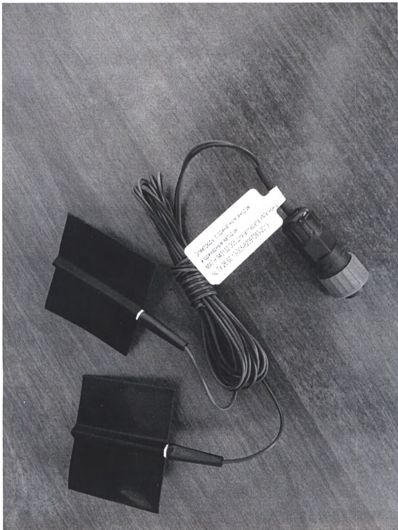
Электроды с одинарным анодом и одинарным катодом МАГН.943132.005
