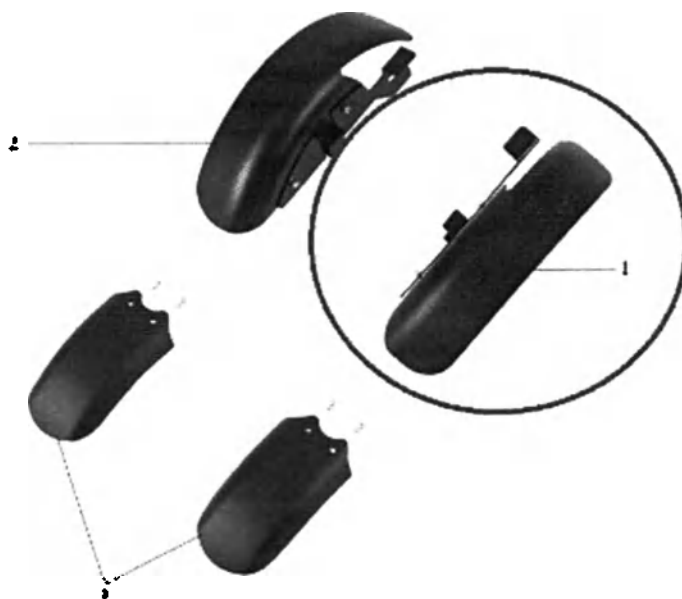
Рисунок 40. Брызговики на колеса
